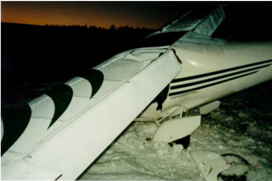
Kuva 4. Koneen maahanosumisjäljet ja vauriot vasemmalla puolella. Päälaskutelineen vieressä irronnut nokkapyörä.
