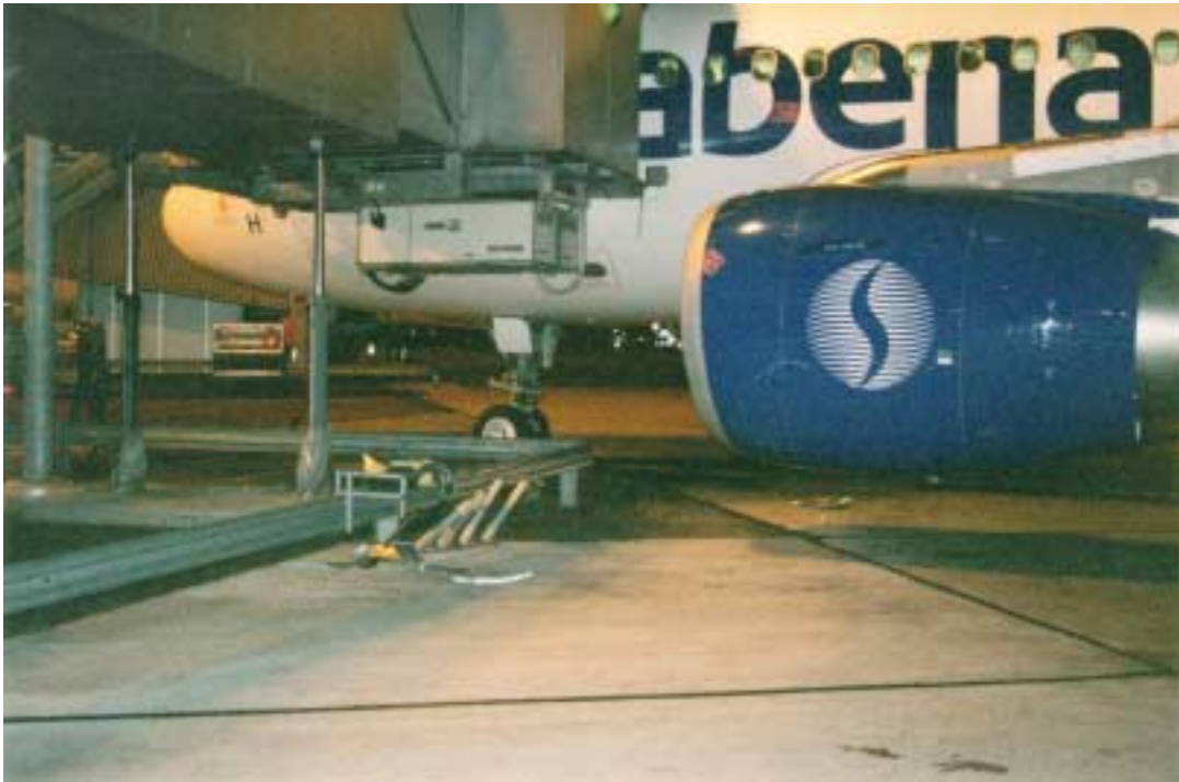
Kuva 5. Romuttuneet tikkaat vaurioituneen moottorin edessä (tikkaat on siirretty syrjään varsinaiselta vauriopaikalta)
