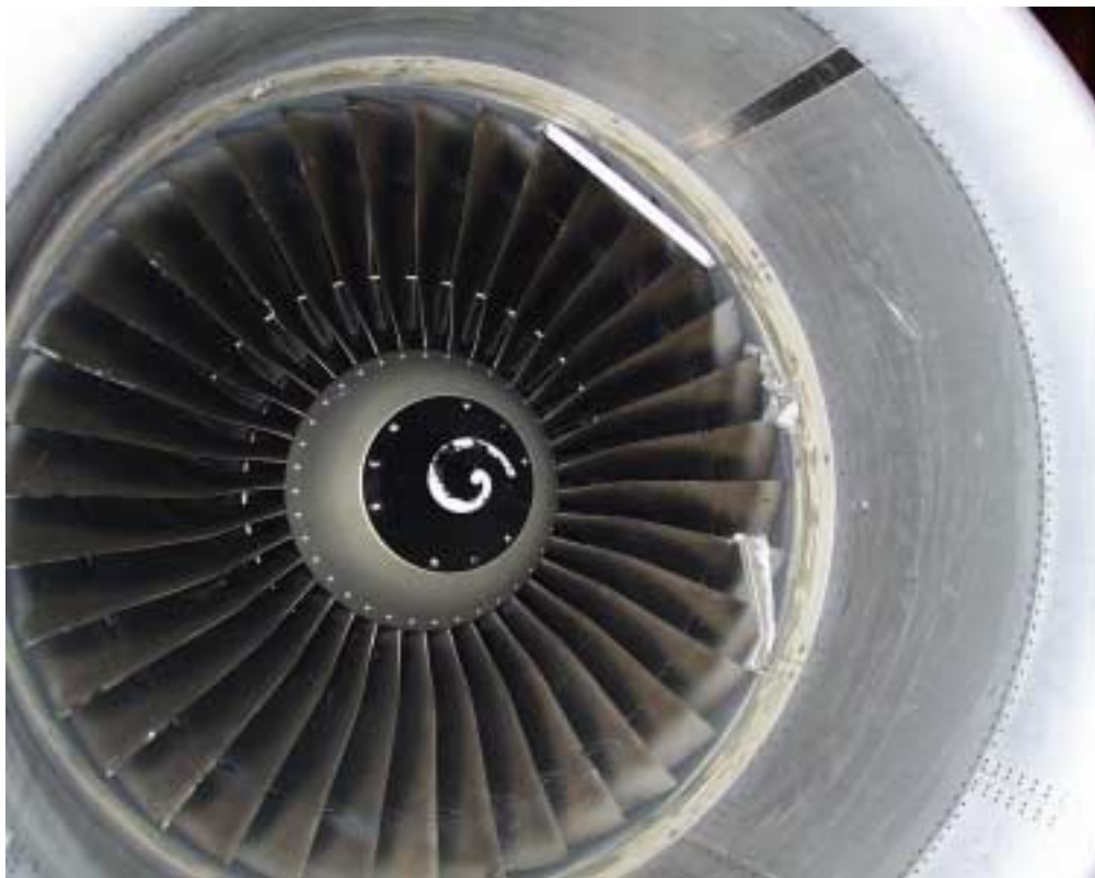
Kuva 4. Yleiskuva vaurioituneen moottorin imaukosta ja siellä olevista huoltotikkaiden osista
