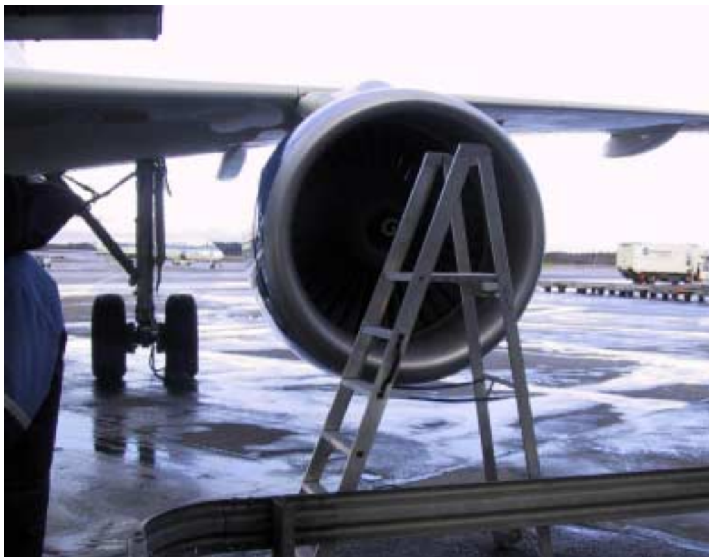
Kuva 3. Jäljitely tilanne huoltotikkaiden paikasta ennen vauriota
