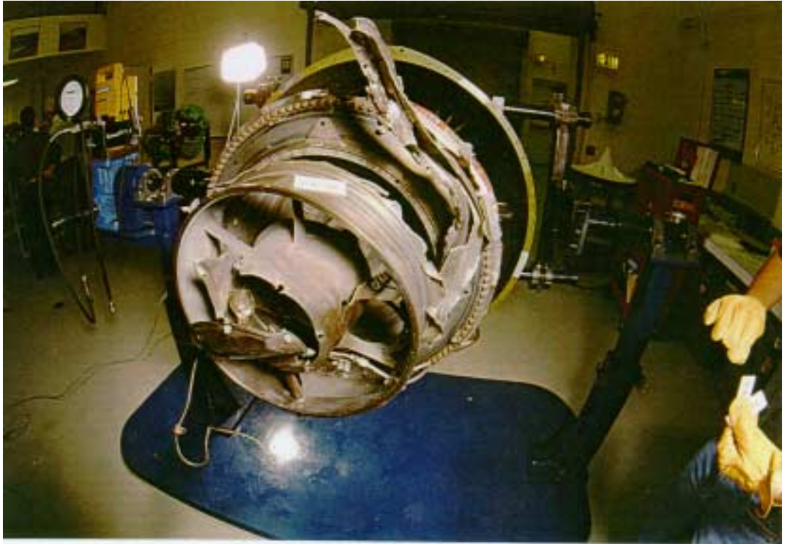
Kuva 3. Moottorin ulosvirtaussuuttimen vauriot moottorin takaa nähtynä.
