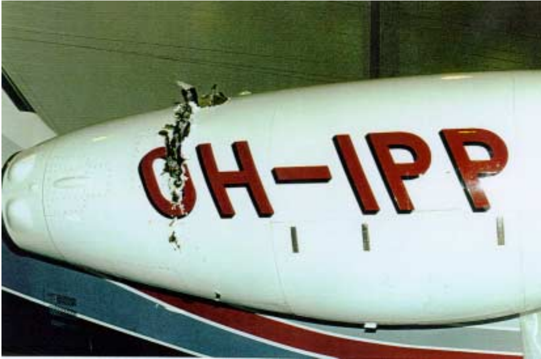
Kuva 1. Moottoripellityksen ulkoapäin näkyvät vauriot.
