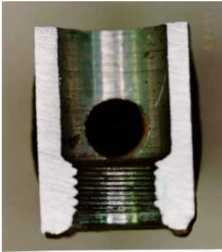
Kuva 5. Pystyputken katkaistu alapää (edellinen kuva) halkaistuna.
