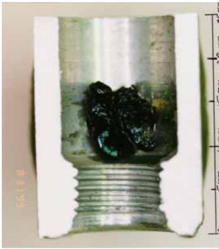
Kuva 6. Kuvassa kärpäset ovat sijoitettuna porauksen päälle, jolloin nähdään, että ne voivat pahimmassa tapauksessa sulkea koko porauksen.
