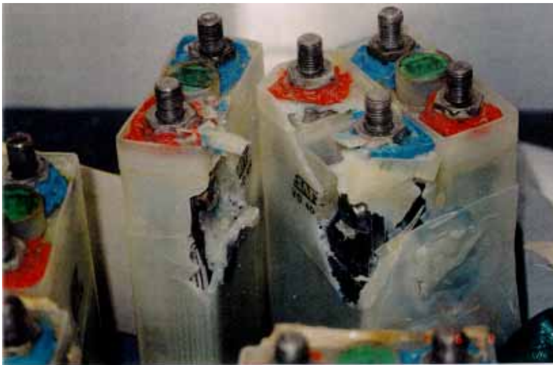
Kuva 3. Akun 2 kennoja. Kennoissa oli isoja reikiä ja osa kennoista oli hitsautunut yhteen. Sulaneet reiät olivat vastakkain.
