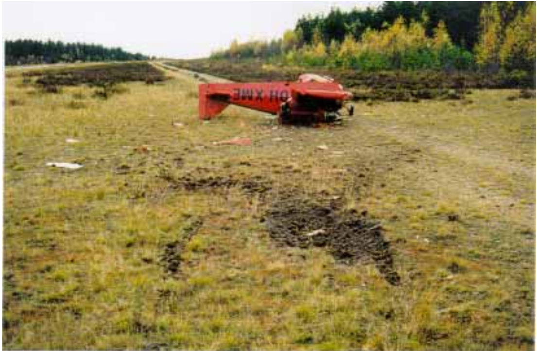
Kuva 1. Lentokone lentosuuntaan kuvattuna. Etualalla maahantörmäyspaikka, jossa oli potkurin jälkiä, joiden perusteella lentonopeus on ollut noin 80 mph (150 km/h).
