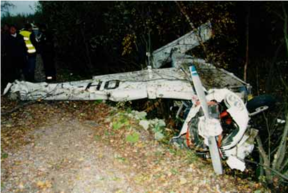
Kuva 1. Kuva onnettomuuspaikalta. Lentokone oli selällään ojassa. Se oli katkaissut ensimmäisen puunlatvan 39 m ennen maahantörmäystä. Oikea siipi oli irronnut osueensaan puihin.
