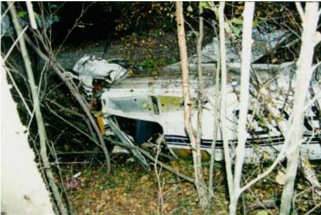
Kuva 2. Kuva rungon oikeasta sivusta. Oikean siiven pääsalko apukiinnityksineen oli katkennut ja siipi oli irronnut. Ovi oli osittain auki.
