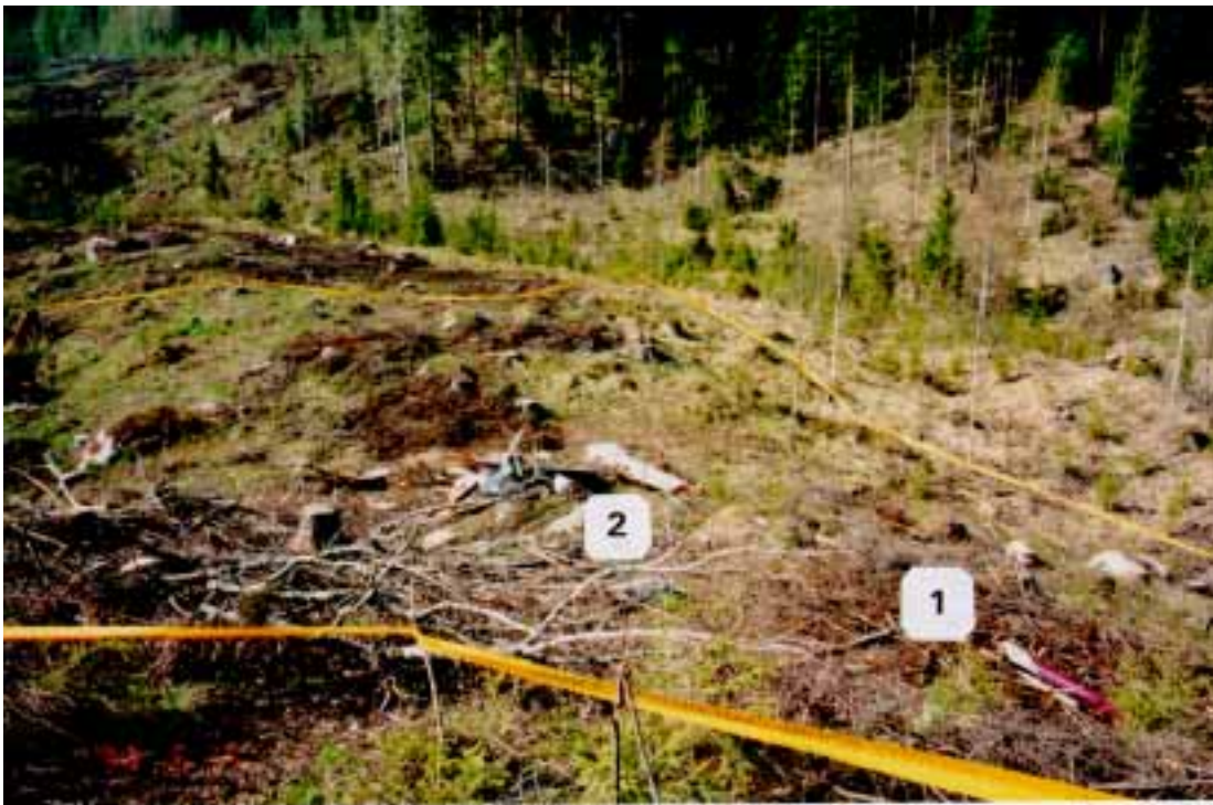
Kuva 2. Kohta 1, oikean siiven maahantörmäyskohta. Kohta 2, nokan maahantörmäyskohta.
