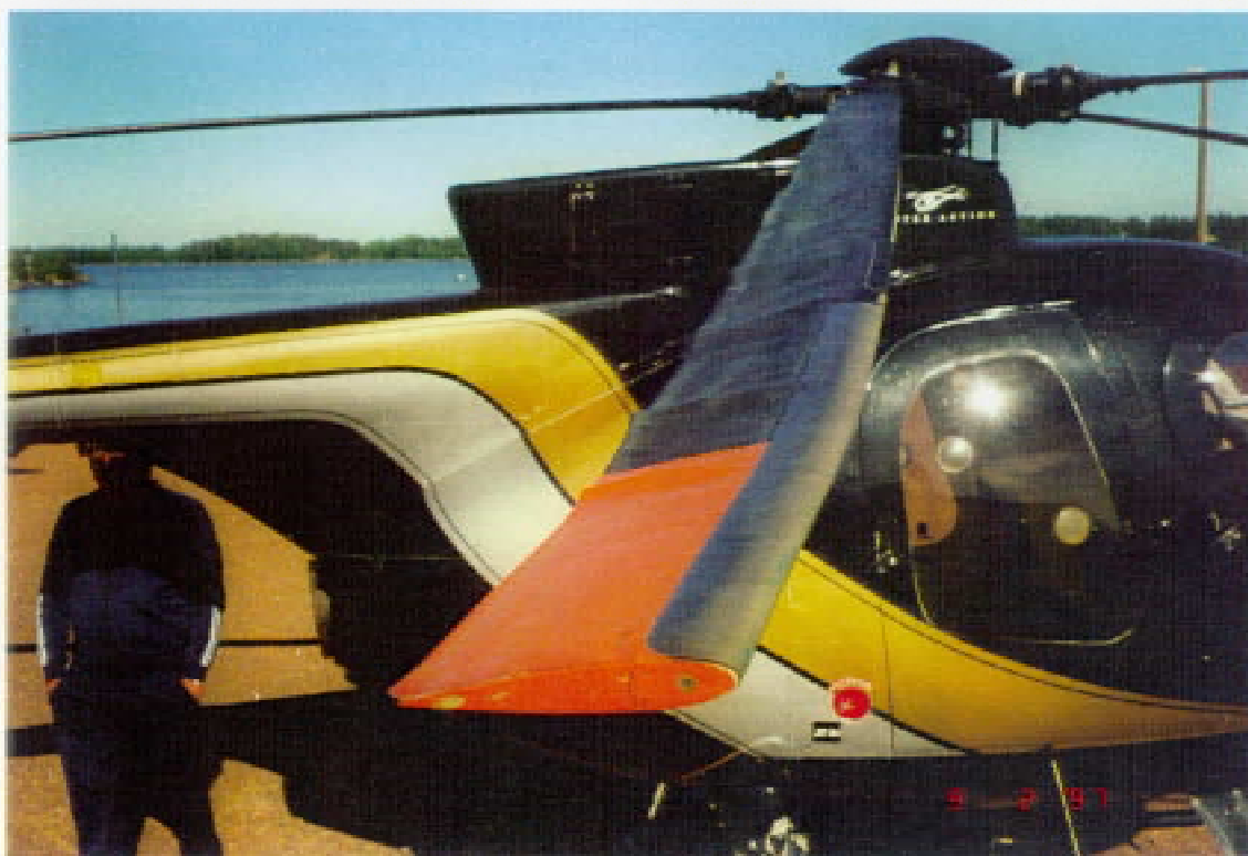
1. Pahiten vaurioitunut päärootorin lapa.
