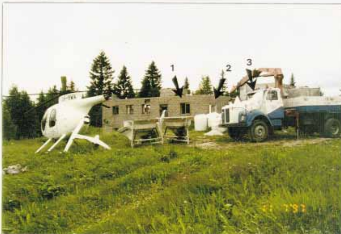
Kuva 1. Yleiskuva vauriopaikalta. Helikopterin nokka osoittaa lähestymissuuntaan. Katkennut pyrstöosa on osittain helikopterin alla. Taustalla näkyy navetan raunio ja kulmahuoneen avonainen ikkuna (nuoli 1) sekä ovi- aukko (nuoli 2). Roottorista lentänyt säkki on kuorma-auton moottoripellin päällä (nuoli 3).
