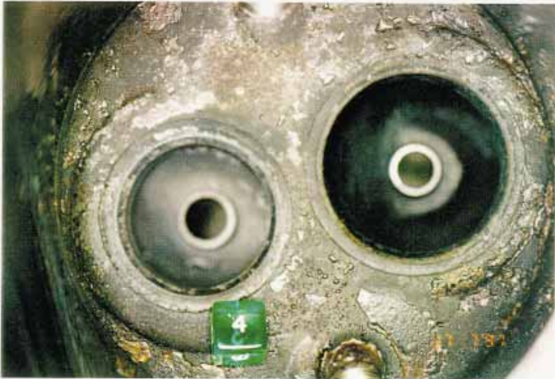
Kuva 3. Sylinterin nro 4 palotilan karsta oli kiiltävän lasimaista ja väriltään lähes mustaa. Muiden sylintereiden palotiloissa karsta oli normaalia vaalean ruskeaa ja pinnaltaan pölymäistä.
