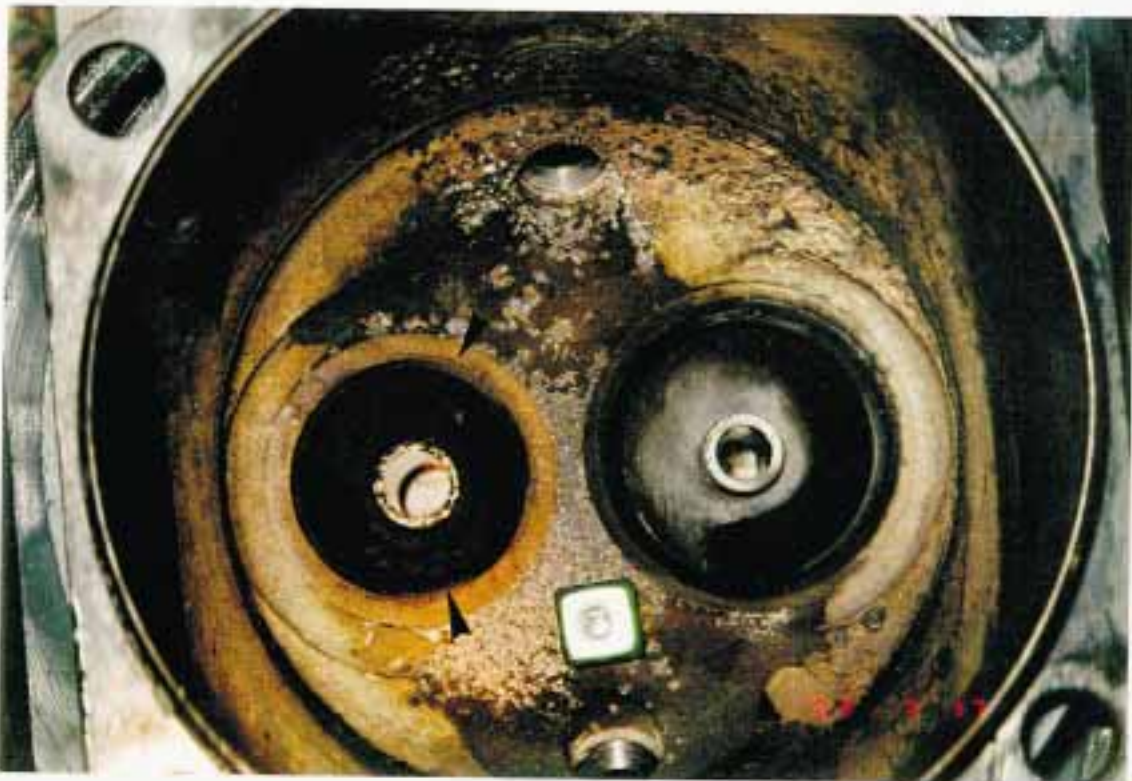
Kuva 4. Sylinterin nro 3 palotilan karstanmuodostus oli normaalia, kuten myös sylinterien 1 ja 2. Nuolet osoittavat pakoventtiilin istukkarenkaassa kohtia, joissa on ollut huono tiiviys.
