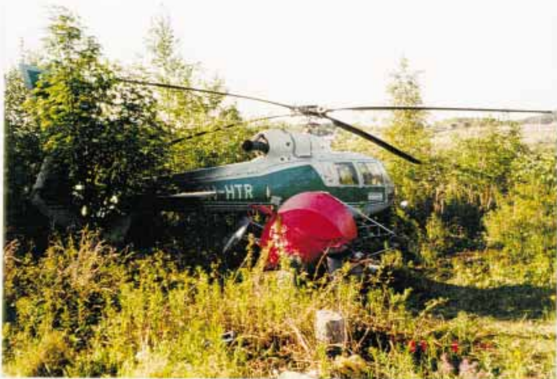
Kuva 2. Helikopteri vauriopaikalla. Helikopterin oikealla puolella on lannoitesäiliö, jonka ohjaaja oli laukaissut irti juuri ennen maahan vajoamista. Levittimen moottori oli sytyttänyt maastopalon helikopterin perärungon alle. Pääroottorin lavat katkaisivat vasemmalla näkyviä koivuja, jolloin lavat vaurioituivat.
