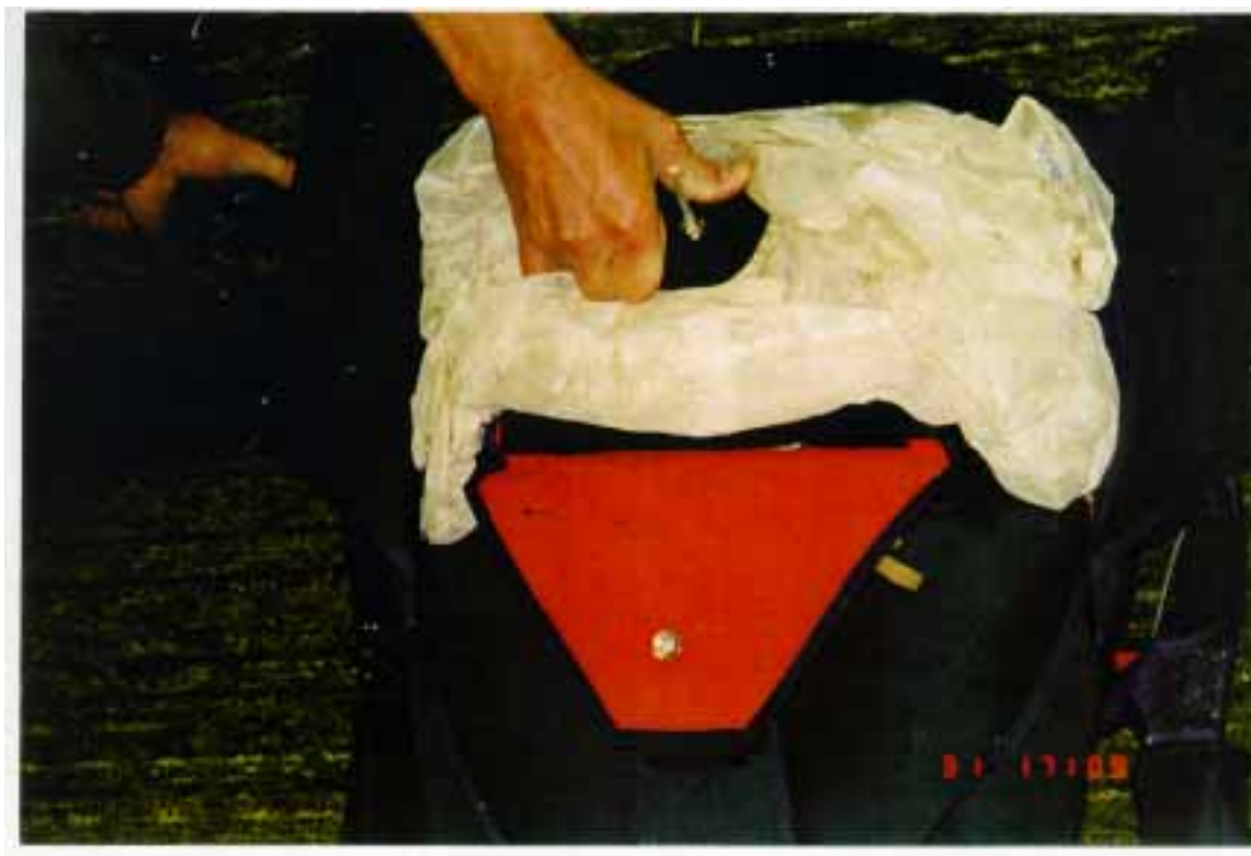
Kuva 3. Onnettomuuslennolla mukana olleen toisen oppilaan päävarjon apuvarjo.
