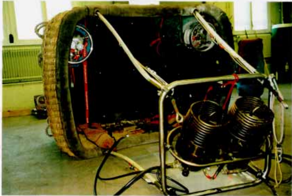
Kuva 3. Korin sisäpuoli oli palanut sen vasemmasta päästä. Kuvassa näkyvät myös polttimet ja niiden kehikko sekä korin ja kehikon väliset nailonsauvat. Kuvassa pallon kupu on irrotettuna. Polttimien massakeskiö kääntää polttimia ylöspäin.
