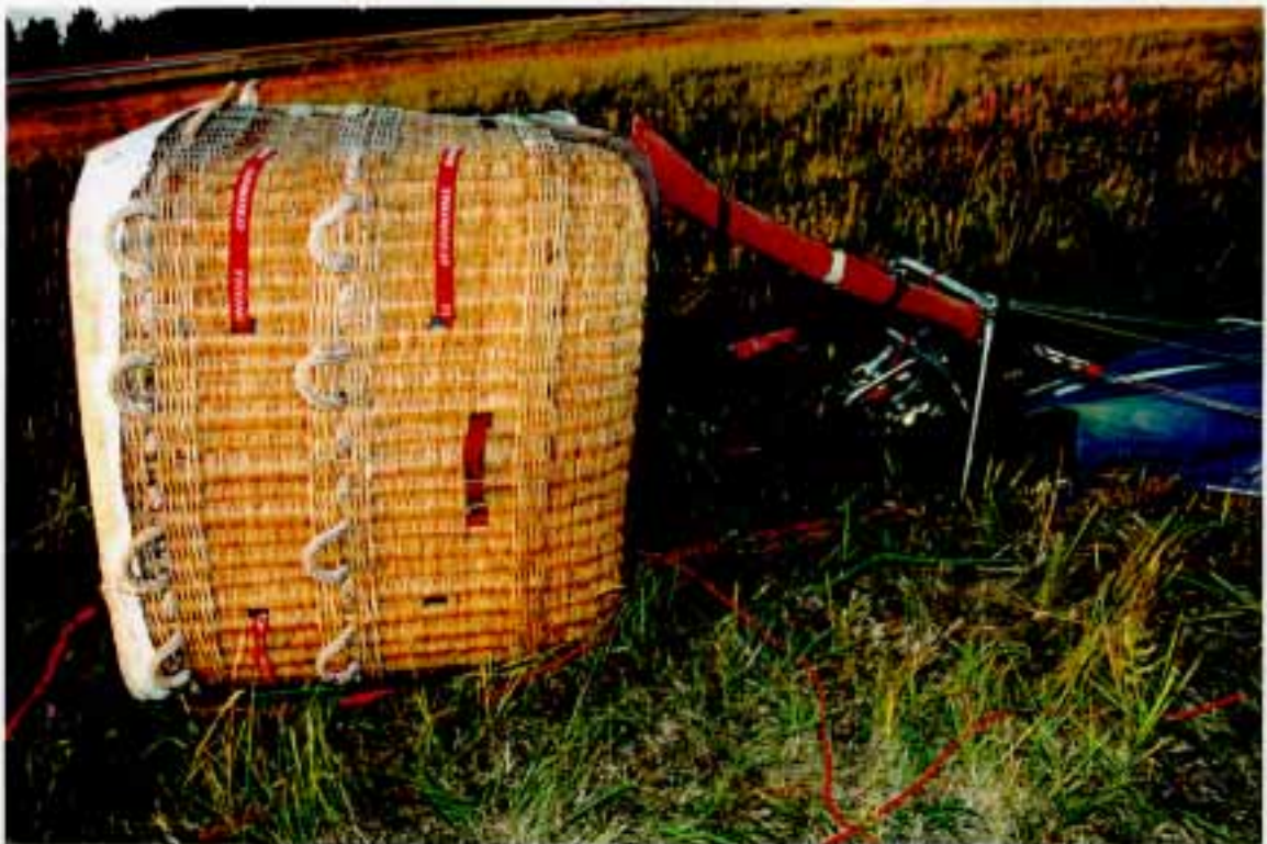
Kuva 2. Kori ja poltin oikealta sivulta kuvattuna. Sinisessä scoopin kankaassa näkyy palovaurio vaaleampana kohtana.
