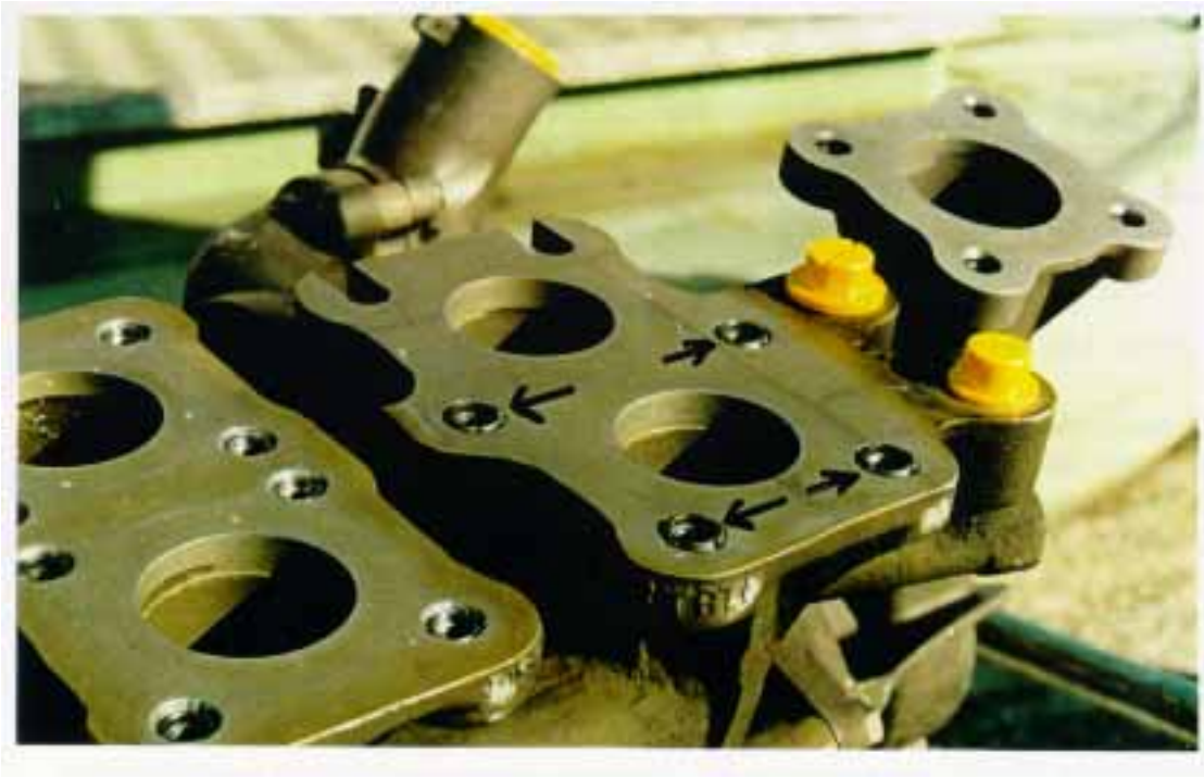
Polttoainepumpun runko. Nuolet osoittavat paikoiltaan nousseita irtokierteitä.
