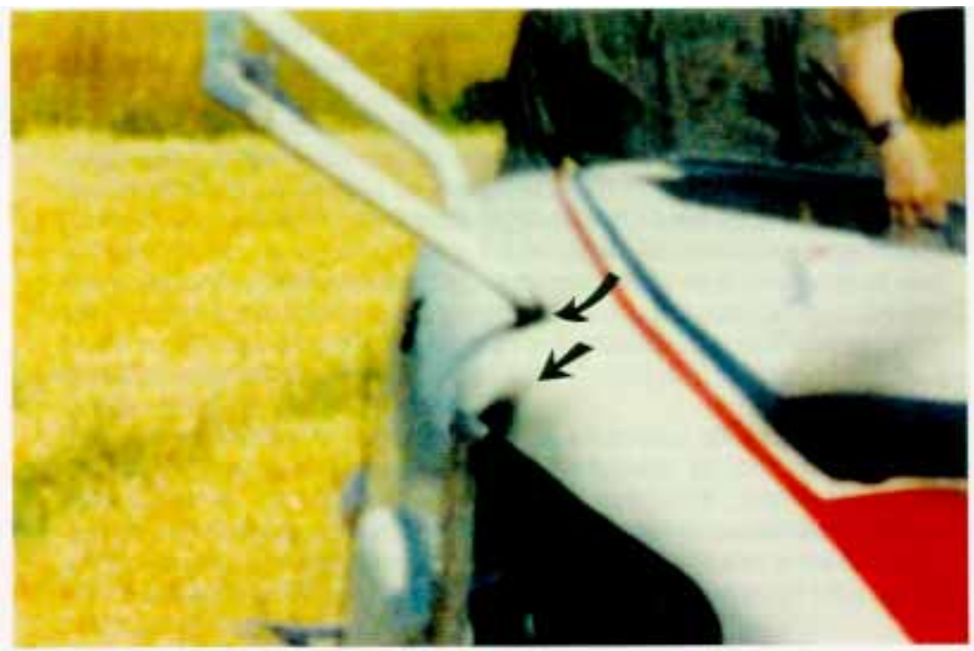
Kuva 2. Helikopteri kuvattuna noin 20 sekuntia edellisen kuvan jälkeen. Rungon pohjaverhouksessa näkyy nokijälkiä. Nokeutumista aiheuttanutta savua ei ole nähtävissä. (Kuvannut Juha Nummela)
