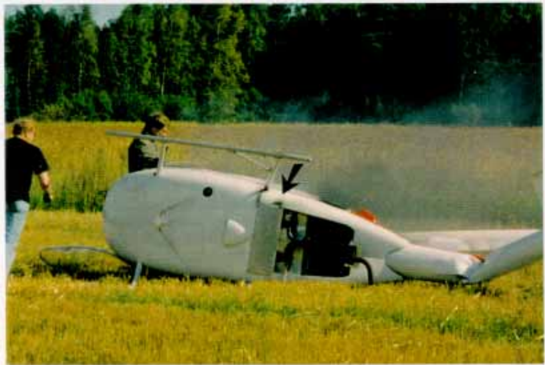
Kuva 2. Helikopteri kuvattuna noin 20 sekuntia edellisen kuvan jälkeen. Rungon pohjaverhouksessa näkyy nokijälkiä. Nokeutumista aiheuttanutta savua ei ole nähtävissä. (Kuvannut Juha Nummela)
