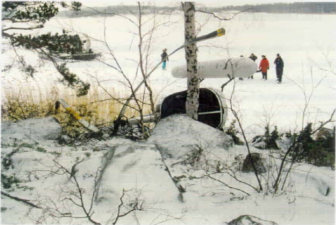
Kuva 3. Tuulilasit ja niiden keskituki rikkoutuivat koivuun törmäyksessä
