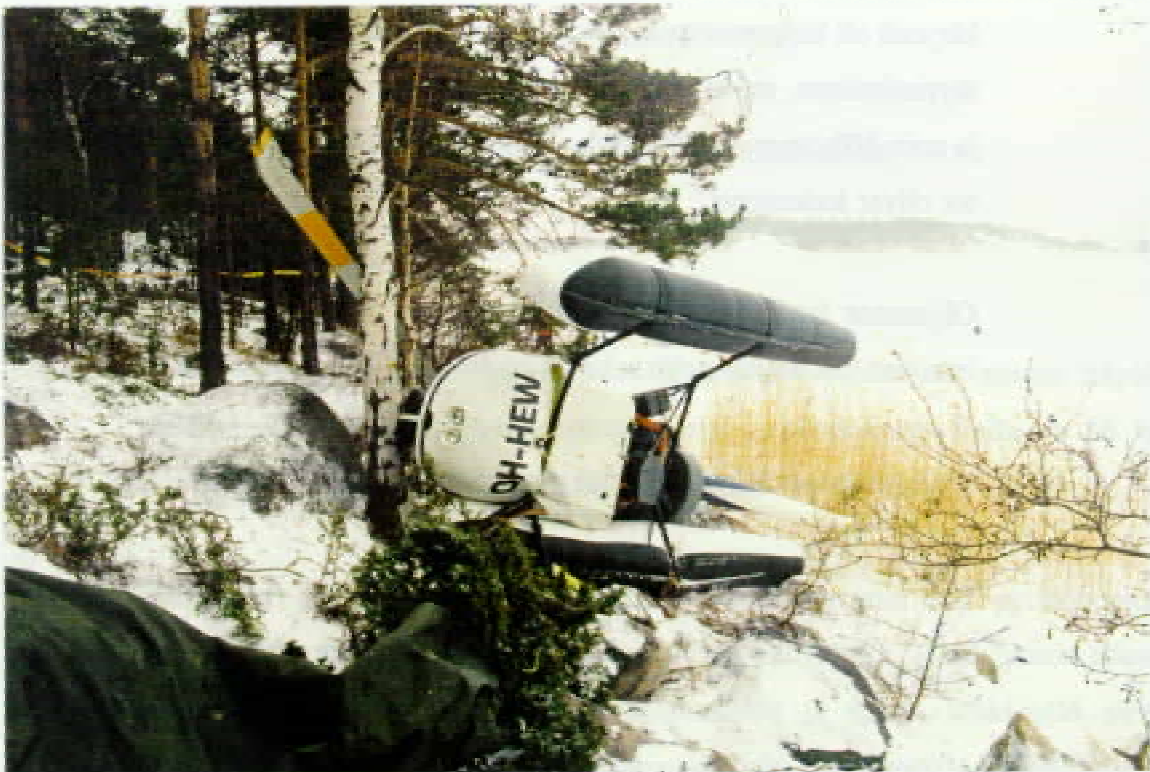
Kuva 2. Helikopteri edestä kuvattuna. Pääroottorin toisen lavan kärki oli katkennut puuhun osumisen seurauksena.
