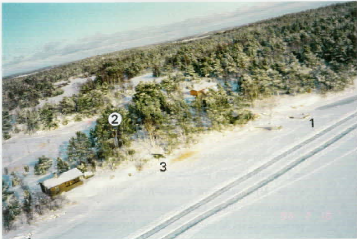
Kuva 1. Lasku- ja onnettomuuspaikka ilmasta kuvattuna. Laskupaikka ja laitur, jossa oli postilaatikko (no 1). Helikopteri nousi puuston yläpuolelle, jossa se osui puun latvukseen ja syöksyi maahan (no 2). Pääroottori iski koivun runkoon ja helikopteri kaatui oikealle kyljelleen (3). Ajotie jäälle aurattiin onnettomuuden jälkeen.
