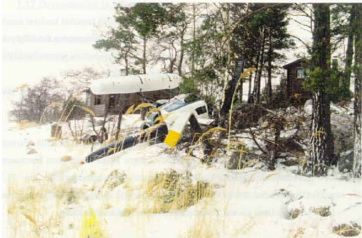
Kuva 4. Pyrstöpuomi ja molemmat pyrstöroottorin lavat katkesivat.
