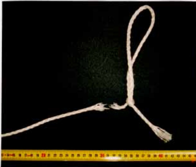
Kuva 2. Hinauksessa käytettiin 24 m pitkää, 5 mm vahvuista propeeniköyttä. Koevedossa sen lujuudeksi todettiin 1950 N (195 kg).
