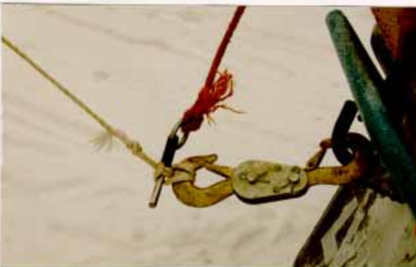
Kuva 3. Narun irroitusta varten itse- valmistettu laukaisutappi.
