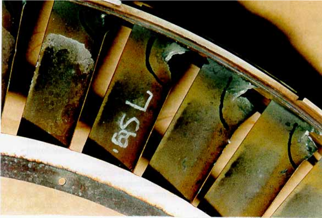
Kuva 3. Ahtimen seitsemännen vyöhykkeen staattorin siipien jättöreunavaurioita
