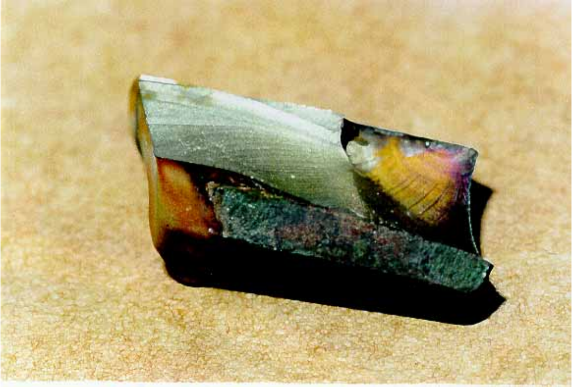
Kuva 1. Ahtimen kahdeksannen vyöhykkeen katkenneen roottorin siiven tyvi
