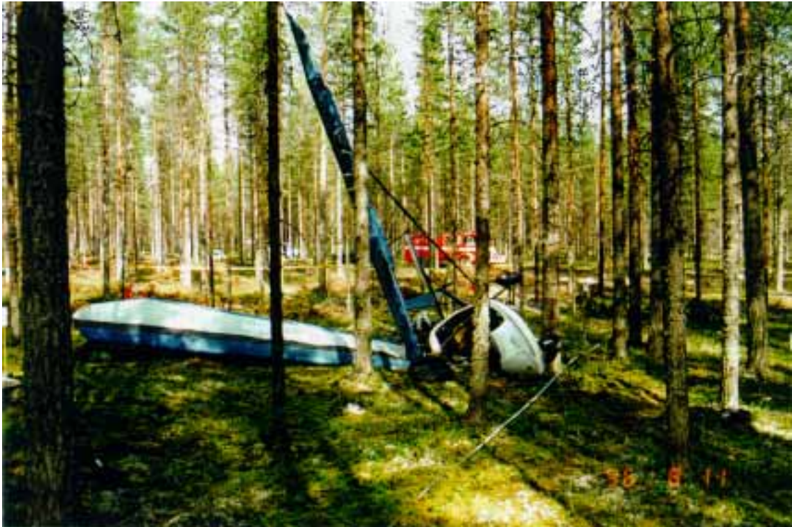
Kuva 2. Onnettomuuspaikka ja lentokone lentosuuntaa vastaan kuvattuna. Oikean siiven siipituet olivat katkenneet puihintörmäyksessä ja siipi oli kääntynyt ylös jo ilmassa.
