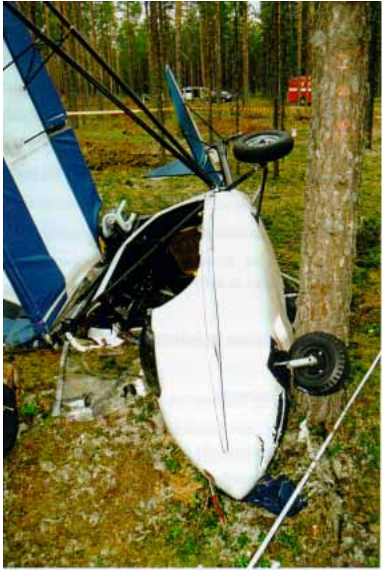
Kuva 3. Lentokone edestä kuvattuna. Ohjaamon rakenteita ja tuulilasi on rikottu pelastustoimien helpottamiseksi.
