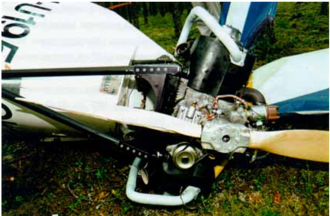
Kuva 4. Runko takaa kuvattuna. Potkurin toinen lapa rikkoutui puuhun törmäyksessä. Samalla potkurin liitos kampiakseliin luisti. Moottorin takakiinnityskorvake murtui maahan törmäyksen seurauksena.
