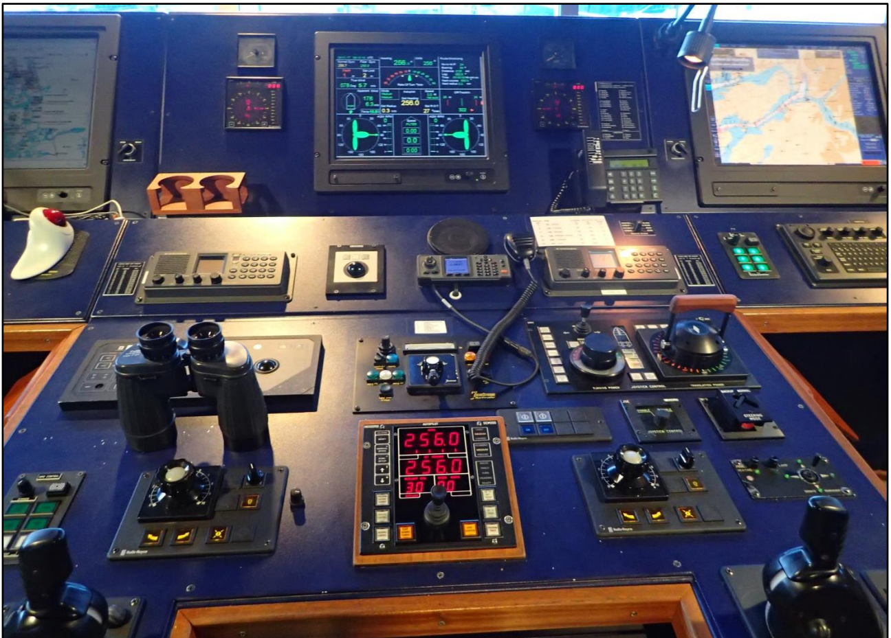
Kuva 5. Keskikonsoli. Conning-näyttö keskellä ylhäällä, ECDIS-näyttö oikealla ylhäällä. (Kuva: OTKES)
