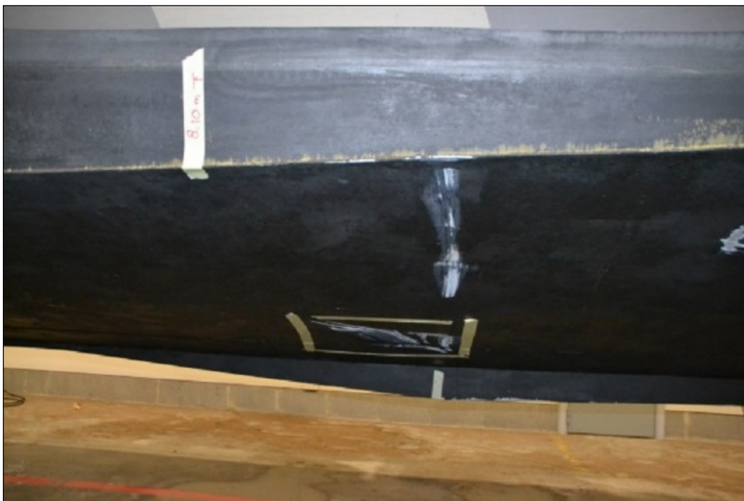
Kuva 7. Viimeiset painaumat veneen pohjassa olivat kaarien kahdeksan ja yhdeksän välillä. (Kuva: OTKES)
