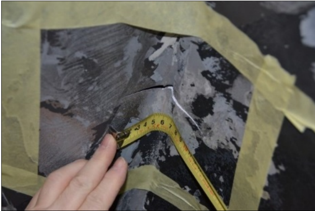
Kuva 6. Keulan repeämä hitsaussaumassa. (Kuva: OTKES)
