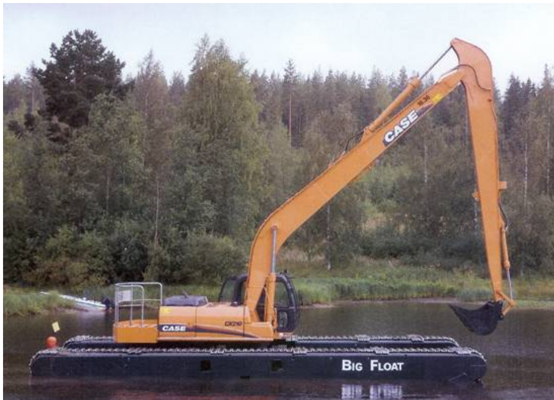
Kuva 1. Onnettomuudessa kaatunut kaivinkone oli tyyppiä BIG FLOAT 16.36. Kuvan laitteessa ei ole lisäponttoneja. (Kuva: REMU Oy)
