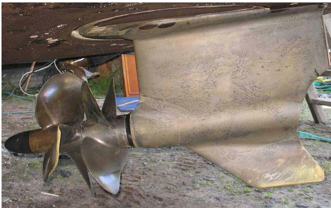
Fig. 15. Oskadat vänster drev som är från 2008, då man bytte det.
