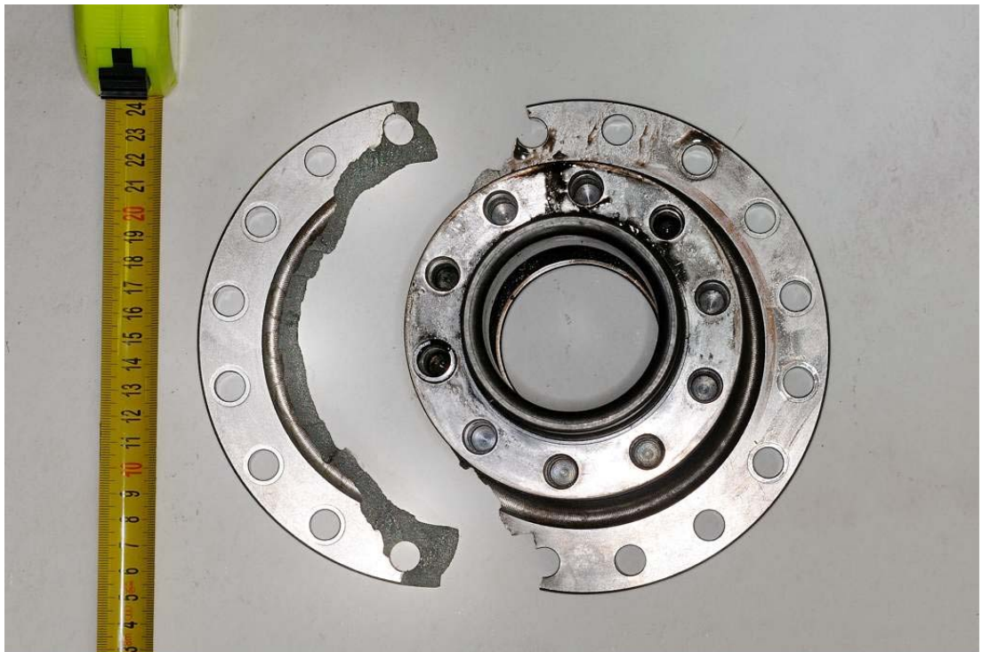
Fig.7 Vridaxeln och dess delvis avbruten fläns.
