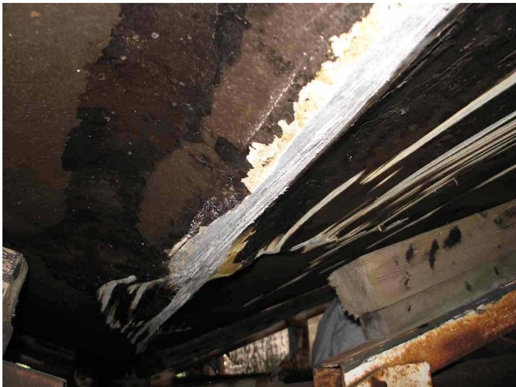
Fig. 17b. Skråmor och lite inåt pressade bottenplåtar nära kölen observerades på båda sidor.
