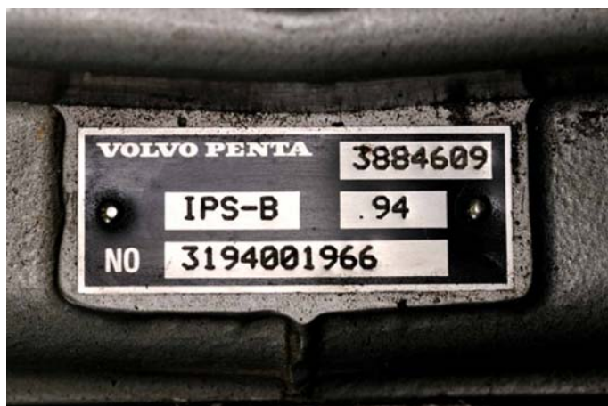
Fig.2. Drevet skilt. Typ är B, utväxlingsförhållande 1,94:1
