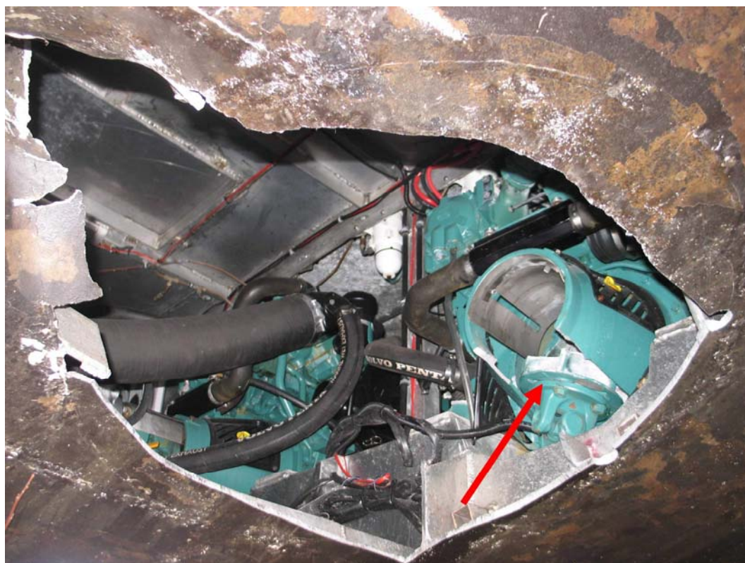
Fig.1. Skuret hål i båtens botten efter lösgöring av drevet. Pilen visar bruten axelkoppling.
