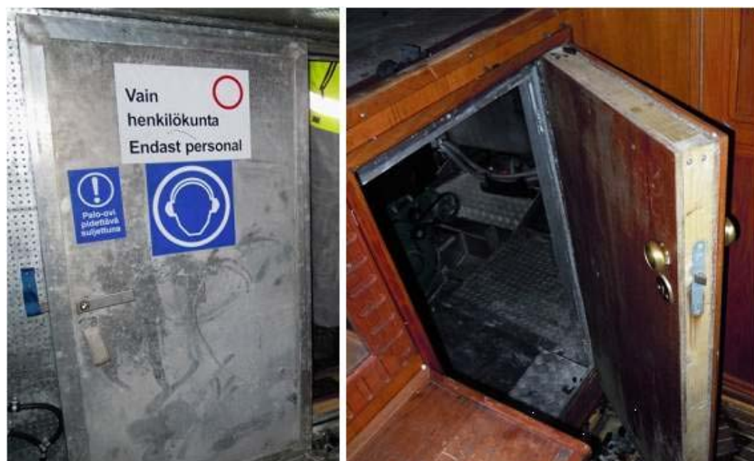
Fig. 8a och 8b. Dörrar till maskinrummet. Till vänster aluminiumdörr i maskinrummets sida. Till höger dörren i passagerarutrymmets sida.
