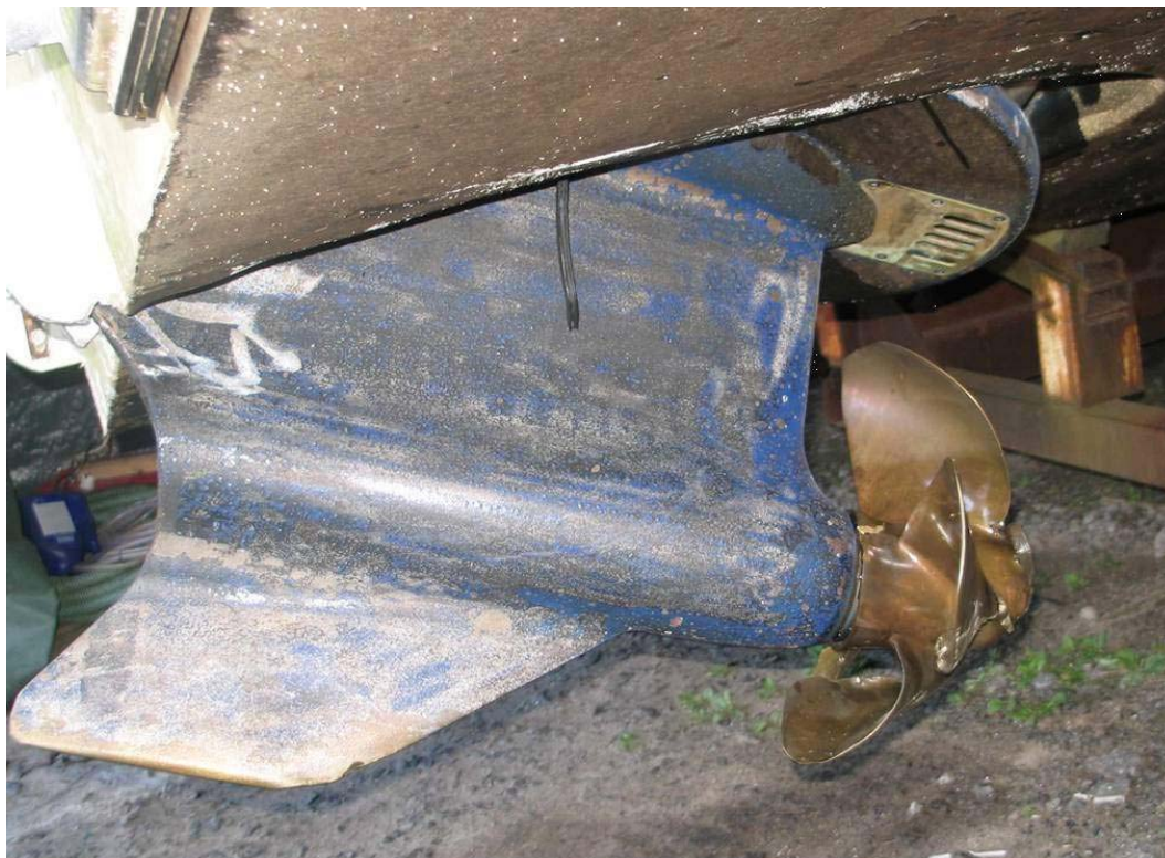
Fig. 16c. Högra drevet vek ca 20 grader nedåt genom fartygets botten.
