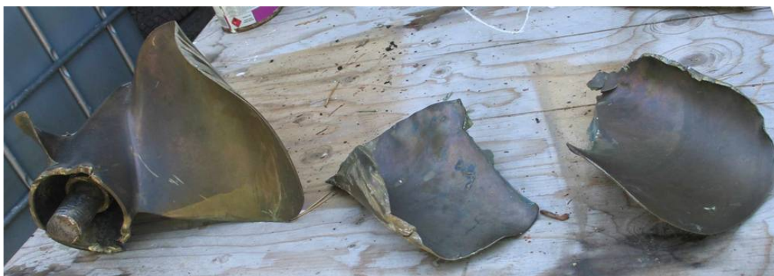
Fig. 16d. Delar av högra drevets främre propeller lyfta från sjön.
