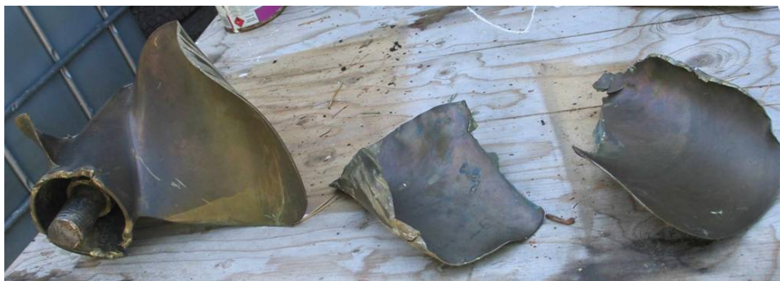
Kuva 16d. Vasemman puolen vetolaitteen potkurin meren pohjasta nostetut osat.
