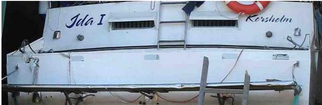
Kuva 9. Konetilan ilmanottoaukot. Kuvattu 19.8.2010 omistajan venevajassa.
