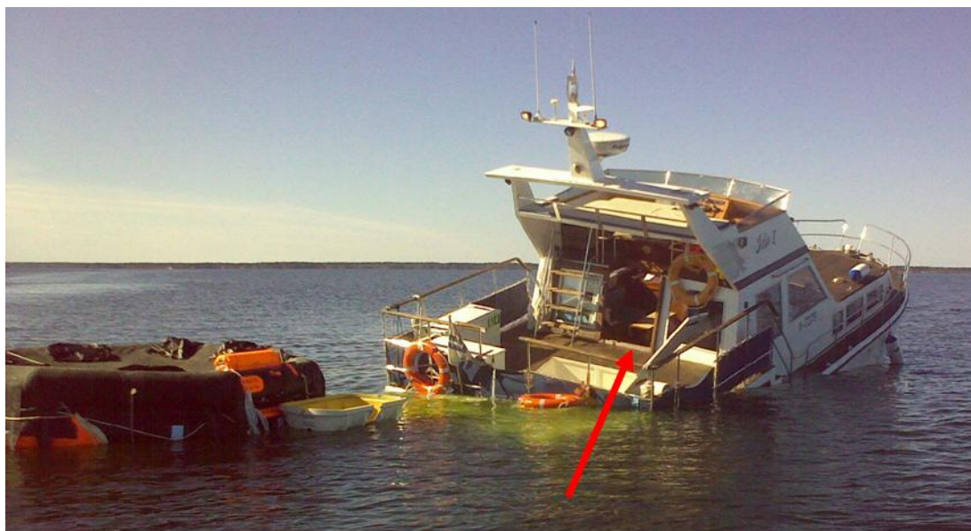
Kuva 12b. Aluksen asento klo 11.41. Veden saavutettua punaisella nuolella merkityn alaohjaamon oviaukon (vuotoaukko), aluksen vajoaminen kiihtyi huomattavasti. Alus on kallistunut oikealle noin 10 astetta. Huomaa nurinpäin oleva 25 hengen pelastuslautta. (© Rajavartiolaitos)
