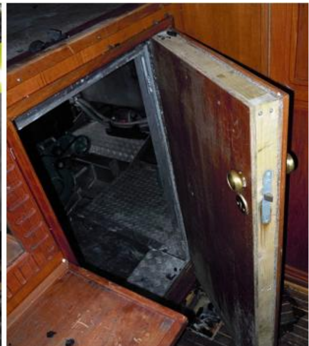
Kuvat 8a ja 8b. Ovet konehuoneeseen; vasemmalla alumiinirakenteinen ovi konehuoneen puolella. Oikealla ulompi puurakenteinen ovi matkustamotilan puolella.
