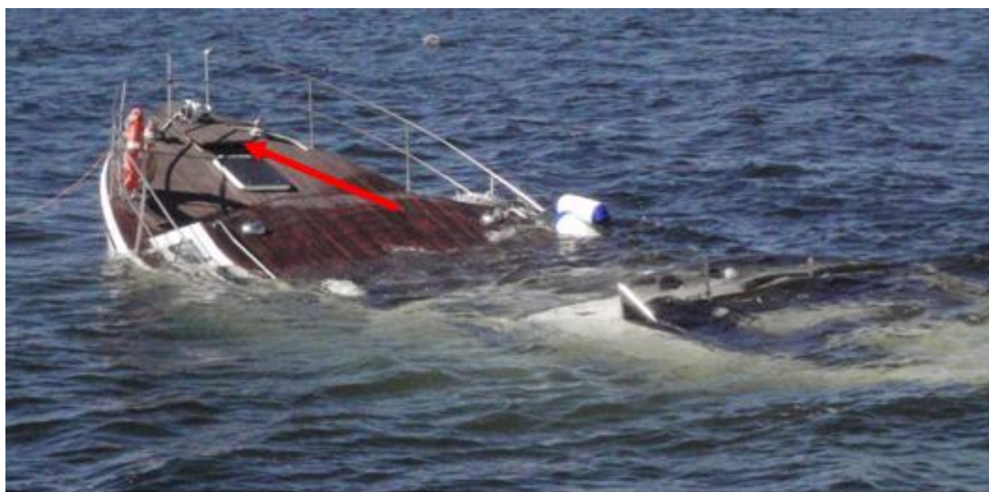
Kuva 13. Aluksen asento klo 14.14. Asento säilynyt samana klo 11.54 jälkeen. Punainen nuoli osoittaa raollaan olevaa keulavaraston luukkuja. (© Rajavartiolaitos)
