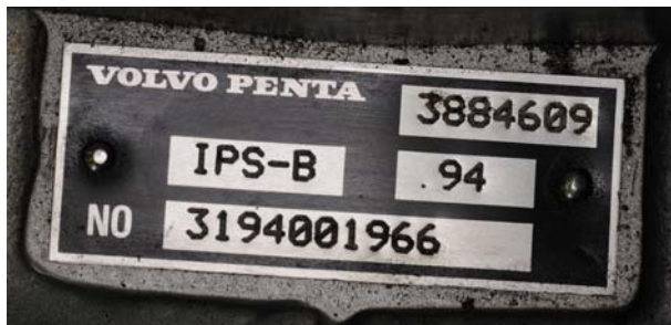
Kuva 2. Vetolaitteen tyypikilpi. Tyyppi B, alennussuhde 1,94:1
