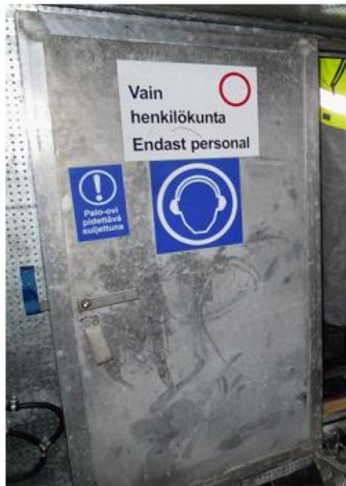
Kuvat 8a ja 8b. Ovet konehuoneeseen; vasemmalla alumiinirakenteinen ovi konehuoneen puolella. Oikealla ulompi puurakenteinen ovi matkustamotilan puolella.
