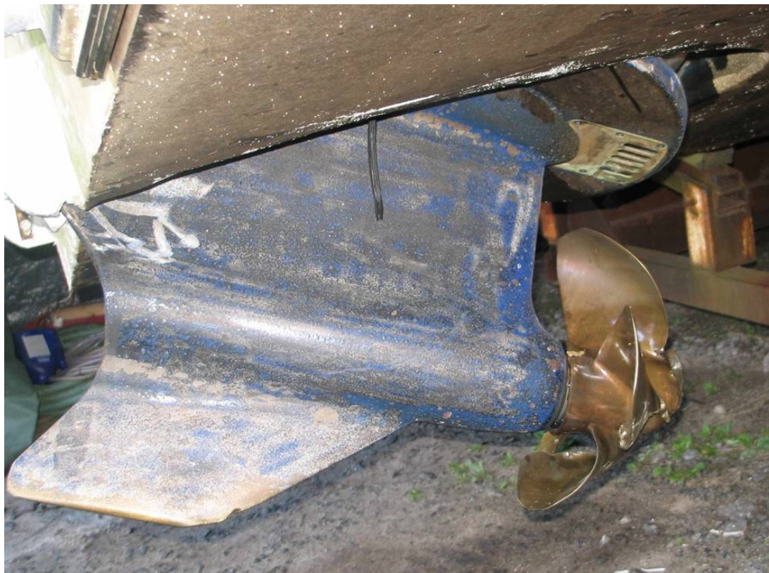
Kuva 16c. Oikean vetolaitteen riki taittui noin 20 astetta alaspäin ja puhkasi aluksen pohjan.
