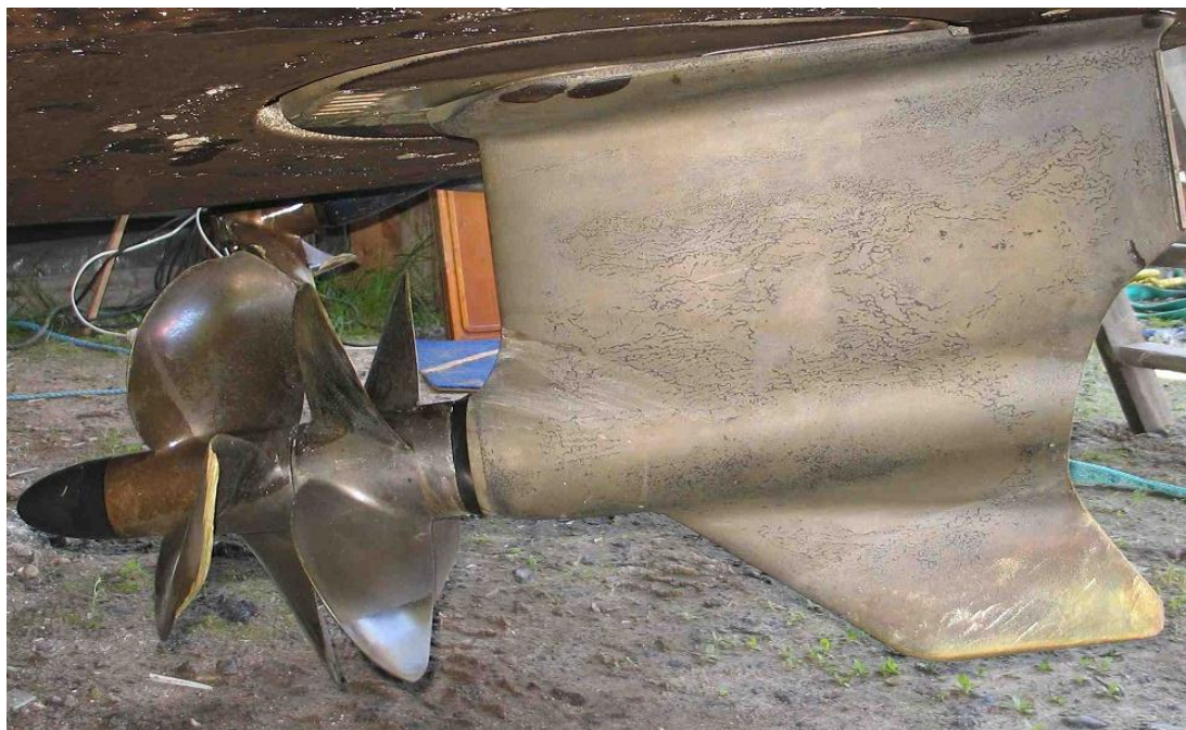
Kuva 15. Vaurioitumaton vasen vetolaite. Vaihdettu vuonna 2008.
