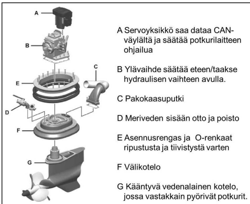
Kuva 2b. Vetolaitteen pääosat eriteltyinä. (kuva Volvo Pentan käsikirjasta.)
