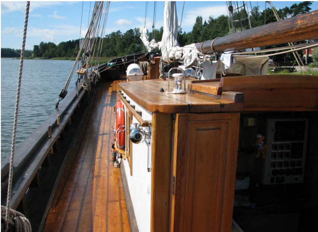
Kuva 16. Kuva on otettu ohjailupaikalta noin 1 m vasemmalle. Navigointi- laitteet ovat avatun kajuutan oven takana. Keulan eteen jää noin 100 metrin katve ohjailupaikalta. (© Onnettomuustutkintakeskus)
