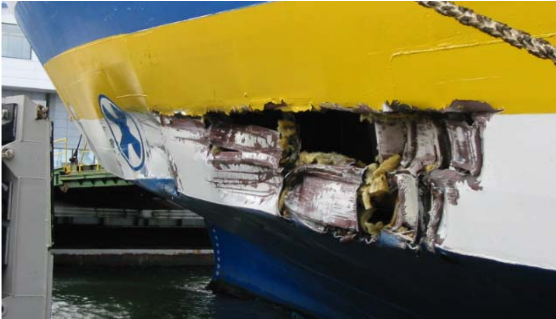
Bild 16. Skadan på vänstra sidan av fören på fartyget NORDLANDIA. Skadan uppstod vid en sammanstötning med kajens fender. Till vänster i bilden ses en dämpande del av en likadan, men hel, fendert.
