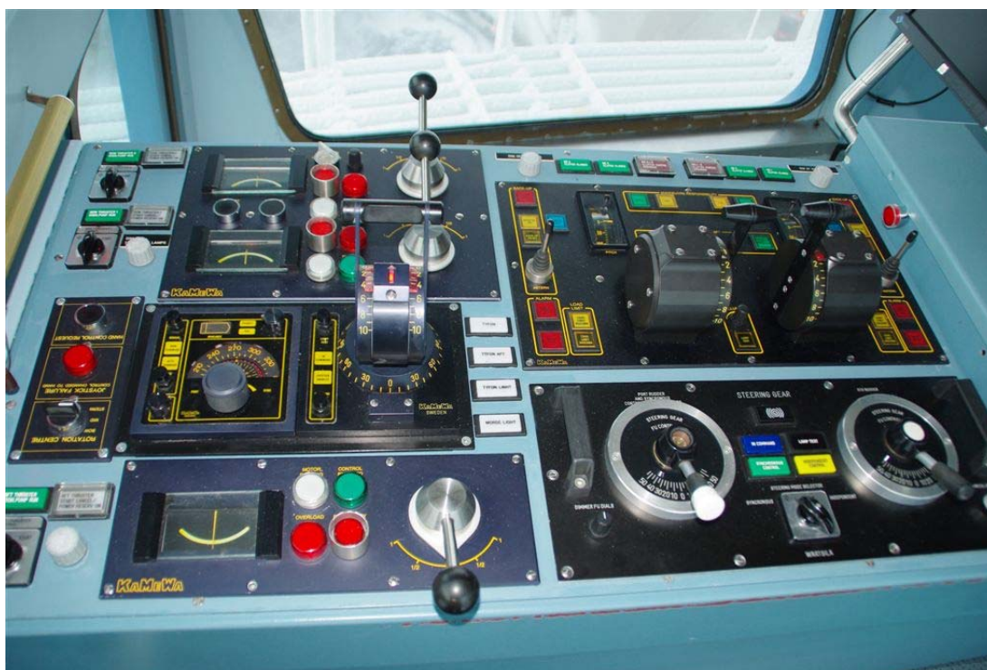
Bild 10. Styrkonsol på kommandobryggans vinge. Bakom till vänster finns regler-spakar för förens styrpropellrar, framför dessa ett joystick-styrinstrument, och framtill styrningen av akterns styrpropeller. Till höger baktill finns reglagen för huvudmaskinerna, och framtill rodrens FU-spakar
