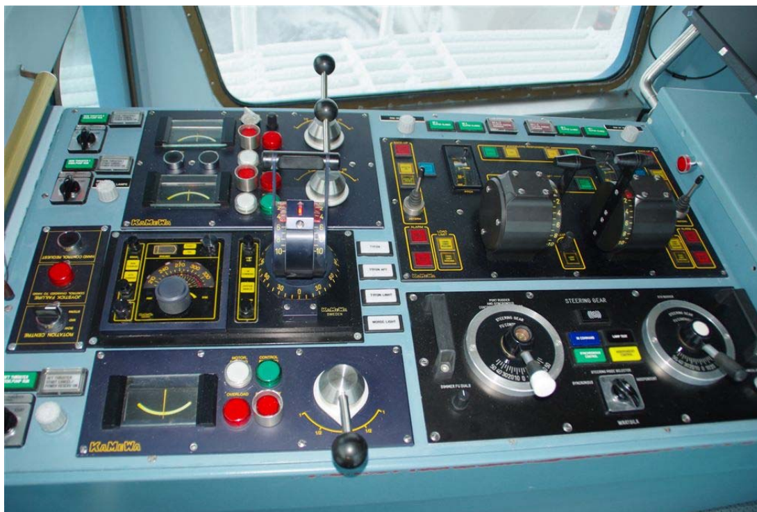
Kuva 10. Komentosillan siiven ohjauskonsoli. Vasemmalla takana ovat keulan ohjailupotkureiden säätövivut, niiden edessä joystick-ohjauslaite ja etualalla perän ohjailupotkurin ohjaus. Oikealla takana ovat pääkoneiden säädöt ja etualalla peräsimien FU-vivut.
