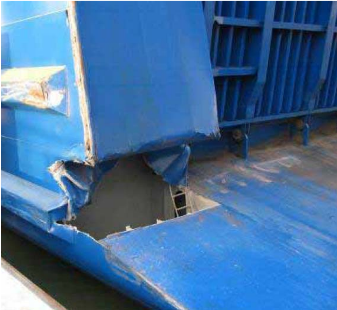
Kuva 19. MS FINNLADYN vaurioitunut perälisäke.
