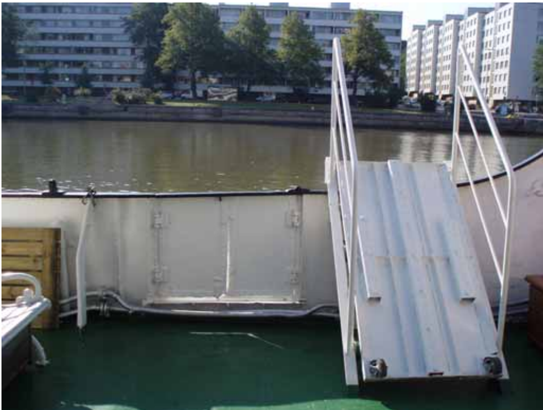
Kuva 4. Evakuointiin käytetty portti ja maihinkulkusilta keulakannella.
