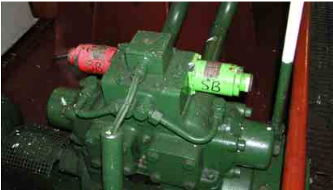
Kuva 4. Ruorikoneen hydraulikkapumppu. Vihreästä napista ruori kääntyy oikealle ja punaisesta napista vasemmalle.
