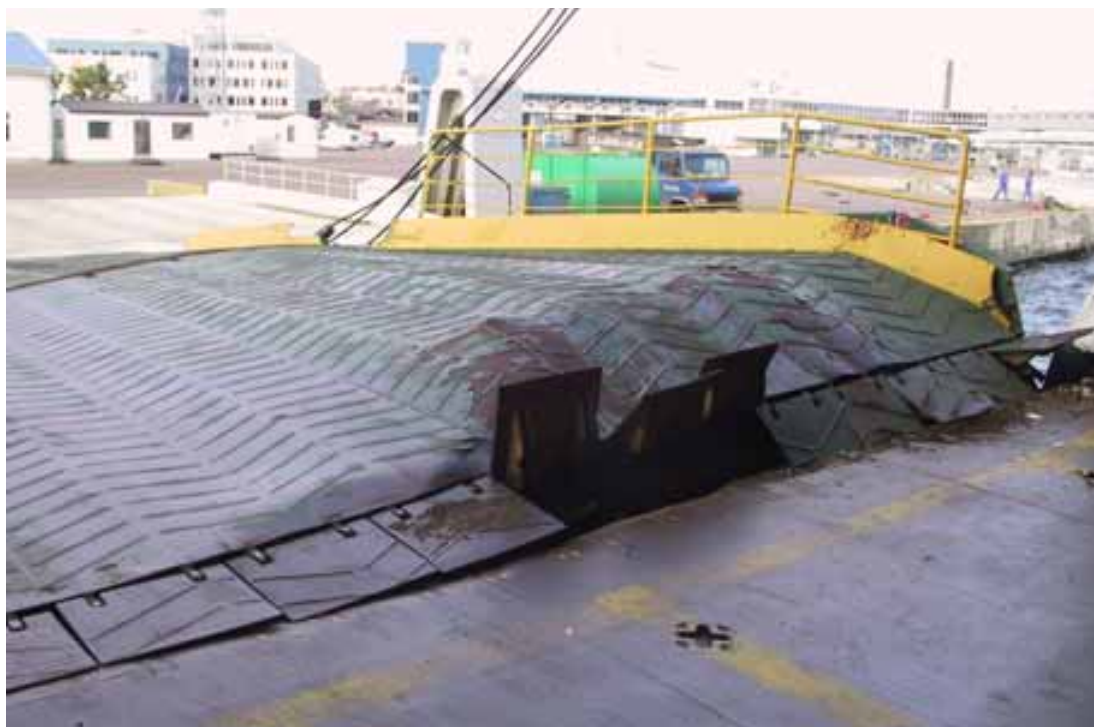
Kuva 8. Aluksen vaurioitunut peräramppi.
