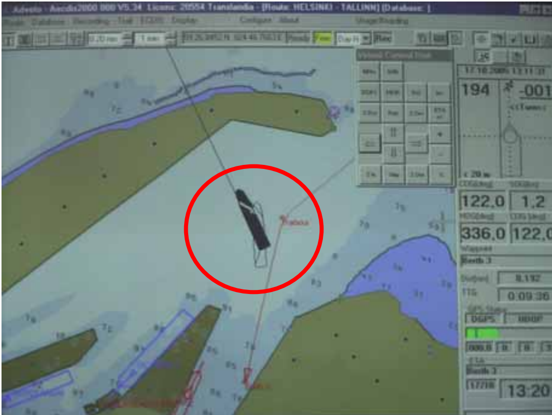
Kuva 2. Prediktori elektronisen kartan näytöllä. Asetettuna aikana 1 min.
