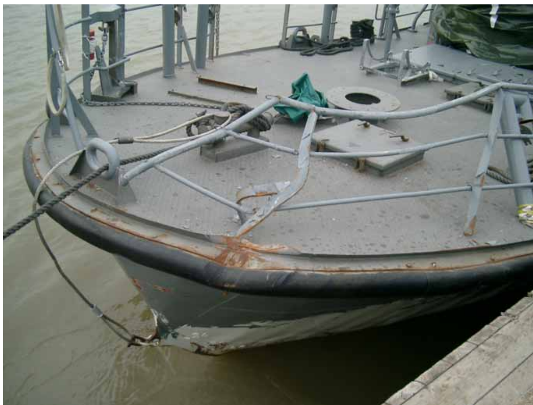
Kuva 7. ROSALA II:n keulan jälki HÖGSÅRAn keulassa.
