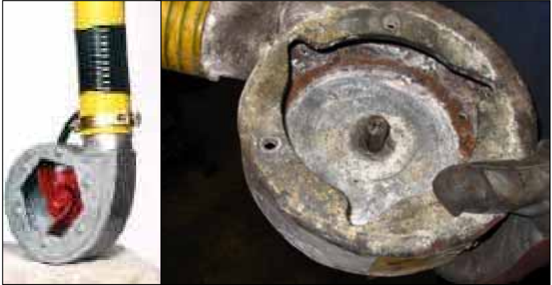
Kuva 5. Pumppu Cobra 90. Vasemmalla on esitteen kuva, oikealla nostetusta aluksesta irrotettu, puhdistettu pumppu siipipyörä poistettuna.
