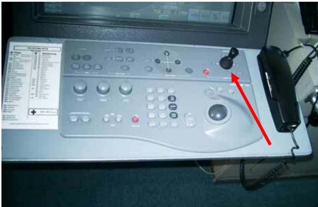
Kuva 6. Päällikön työpiste ja nuolella osoitettu override-ohjaussauva.
