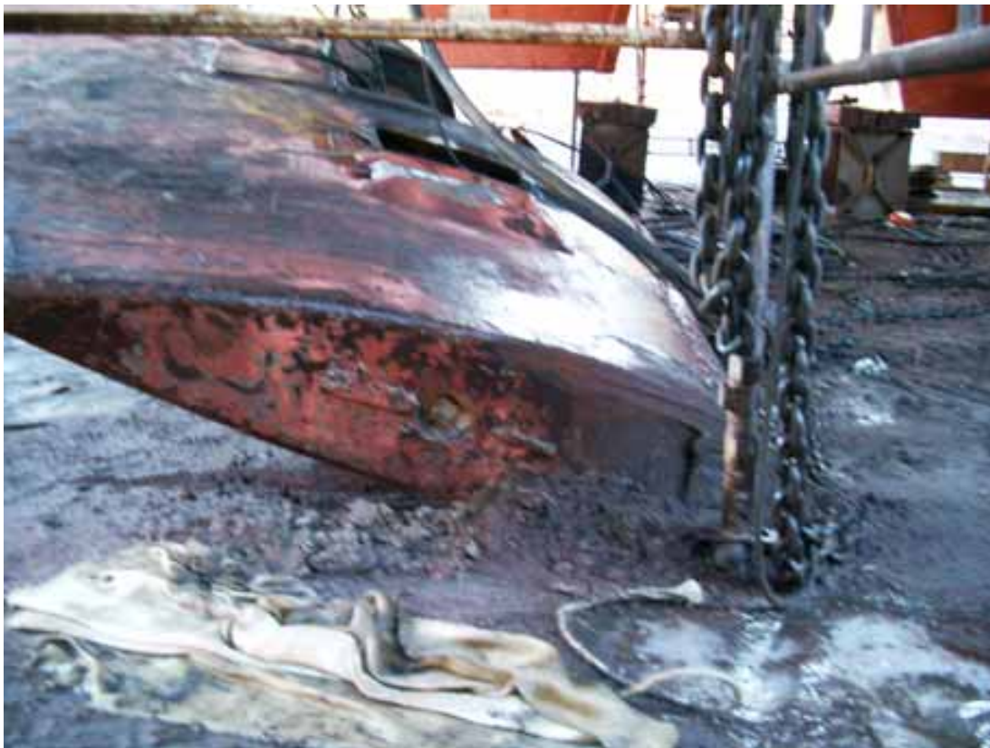
Kuva 8. Peräsimen saama vaurio.
