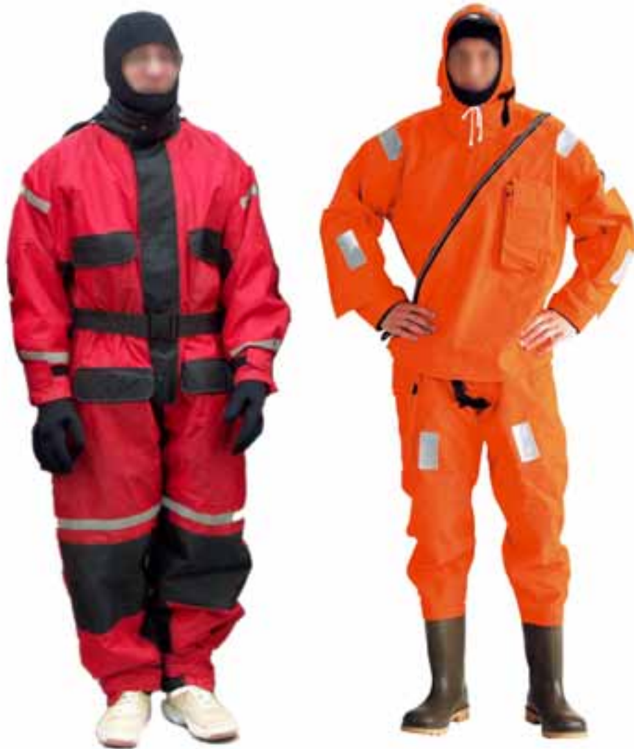
Kuva 12. Onnettomuudessa mukana ollut, tavanomaista tyyppiä olevat kelluntahaalarit (vasemmalla) ja virallisesti hyväksytty pelastautumispuku (oikealla). Nämä ovat kaksi aivan eri tuotetta eikä niitä saa pelastautumisominaisuuksiensa osalta sekoittaa toisiinsa. Pelastautumispuvun oleellinen ero kelluntahaalareihin nähden on täysi vesitiiveys, jonka seurauksena puku suojaa kylmettymiseltä vedessä.
