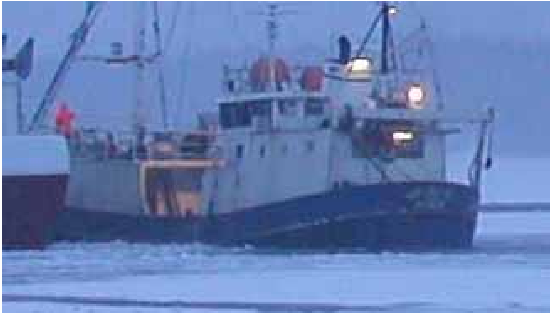
Kuva 13. NORDSJÖn asennon arviointi tyhjennyksen aikana. Perä on korkealla, ts. aluksella on melko suuri keulaviippaus. Syväys on edelleen lähes 3,5 m. Aluksella on ilmeisesti vielä pieni kallistuma oikealle.
