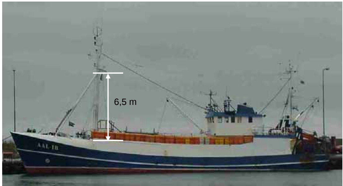
Kuva 2. SEA GULL. Kuvassa on aluksen vasen laita. Alus oli rakenteeltaan epäsymmetrinen, vertaa kuvaan 3 ja yleiskuvaluonnokseen, kuva 9. Kalapussia nostettaessa pussin tukipiste oli noin 6,5 m korkeudella keulapakan kannesta. Kuvassa 7 näkyy tukipiste sivusuunnassa. Nostossa alus kallistui oikealle. Kuvassa aluksen keulan syväys on noin 2 m ja perän 2,7 m. Kuvassa näkyy myös keulapotkurin merkki.
