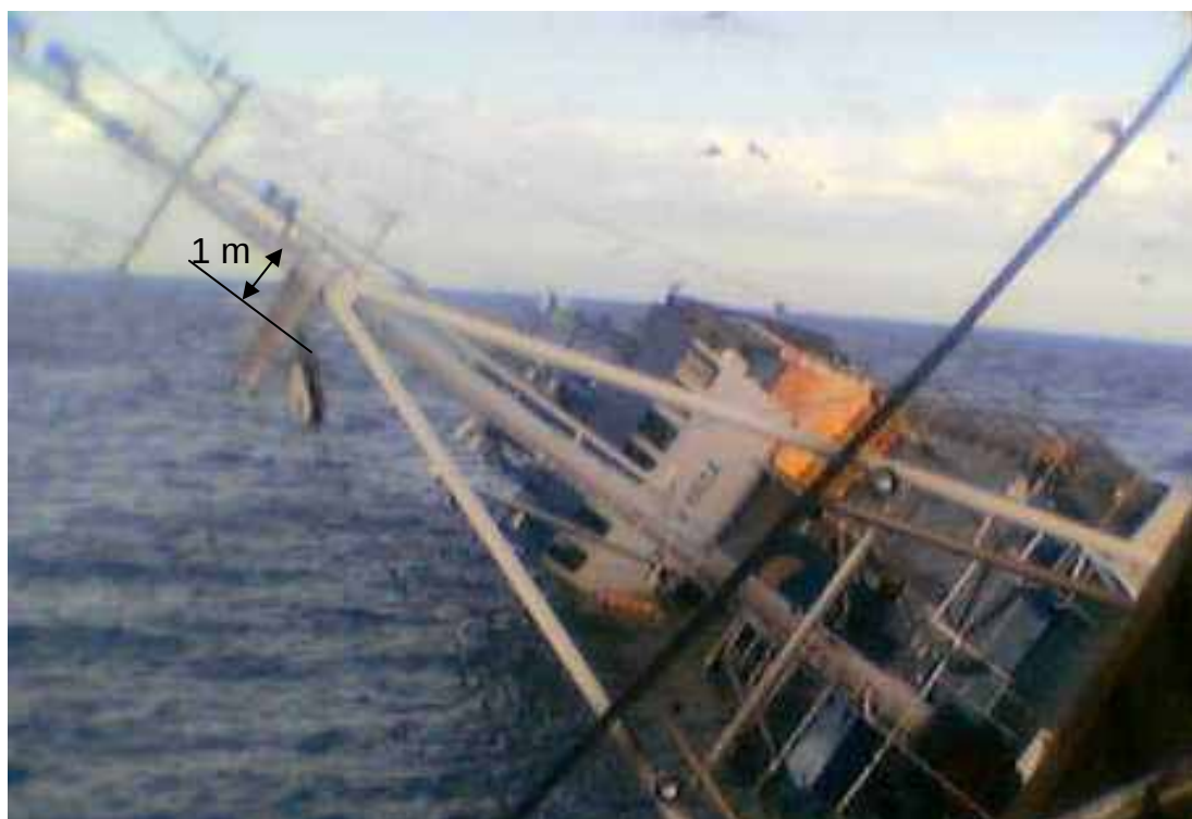
Kuva 7. SEA GULL kuvattuna 27.5.2004 aamulla noin klo 5. Alus oli tuolloin kallellaan noin 55 astetta. Noston tukipiste on noin 1 m sivussa keskiviivasta.
