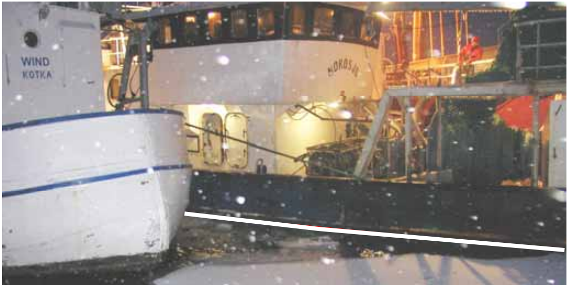
Kuva 4. NORDSJÖ kiinnitettynä WINDiin aamulla 27.1.2004 Perärakennuksen ja keulapakan ovet ovat auki. Aluksen syväys näyttää ulottuvan lähes pääkanteen saakka (arvioitu vesiraja näytetty valkoisella viivalla). Aluksen kallistuma on ilmeisesti lähes oikaistu.
