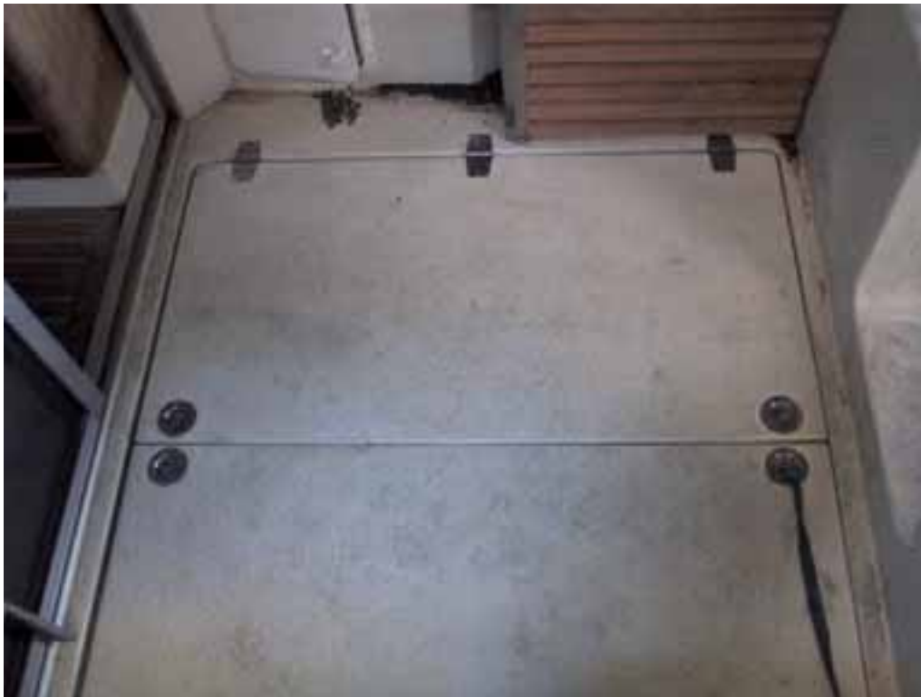
Kuva 5. Sun 33 -veneen konetilan luukku suljettuna. Kuvasta näkyy, että luukku oli pelkästään saranoiden varassa ilman varsinaisia kiristimiä. Luukun nurkissa näkyvät kiristimet toimivat lähinnä sulkimina eivätkä kykene tiivistämään luukkua ympäri kehää.
