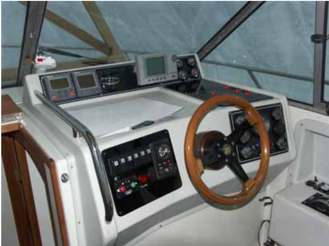
Kuva 20. Onnettomuusveneeseen sisäohjaamon mittarit. Kuva on otettu veneen korjauksen jälkeen vuonna 2004. Eteen näyttävä kaikuluotain (sonari) on asennettu veneeseen onnettomuuden jälkeen ja sillä on korvattu onnettomuushetkellä veneessä ollut kaikuluotain.
