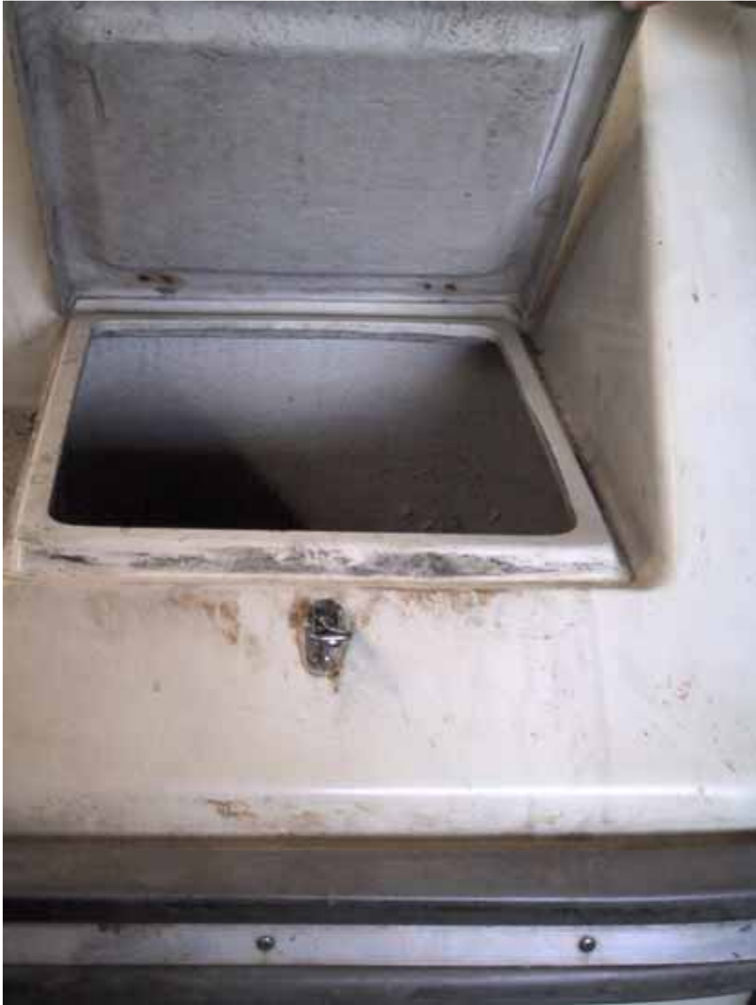
Kuva 8. Uimatason kotelon kansi onnettomuuden jälkeen ennen korjausta. Kuvasta näkyy, että kansi ei ollut vesitiiviisti suljettavissa. Kannen joutuessa veden alle vesi pääsi täyttämään kotelon.
