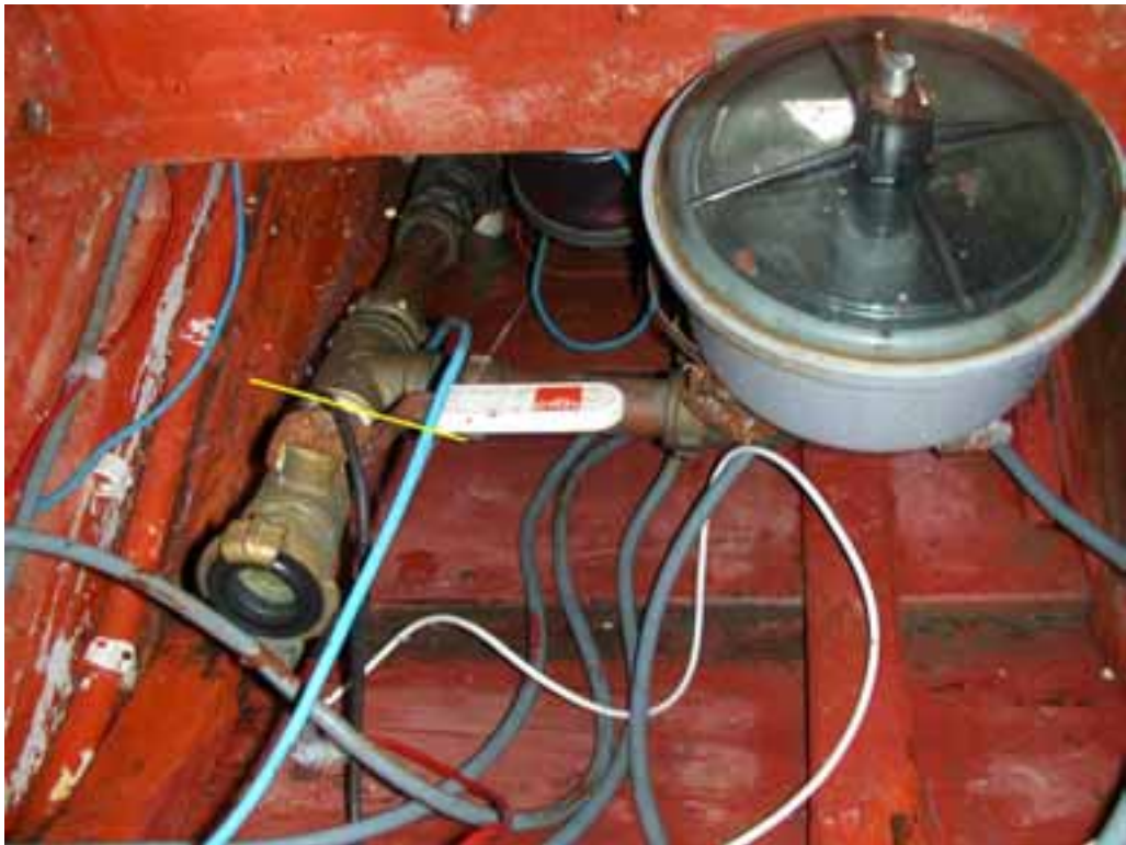
Kuva 5. Merivesiputkisto. Piirrosmerkki osoittaa katkeamiskohdan.
