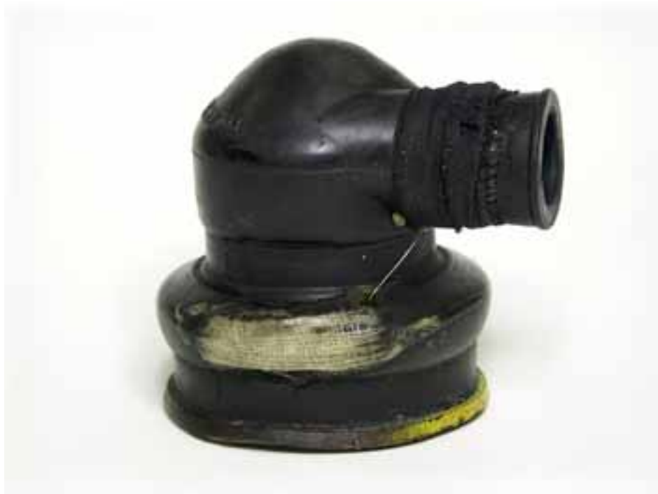
Kuva 3. Vaurioitunut osa tilapäiskorjauksen jälkeen.
