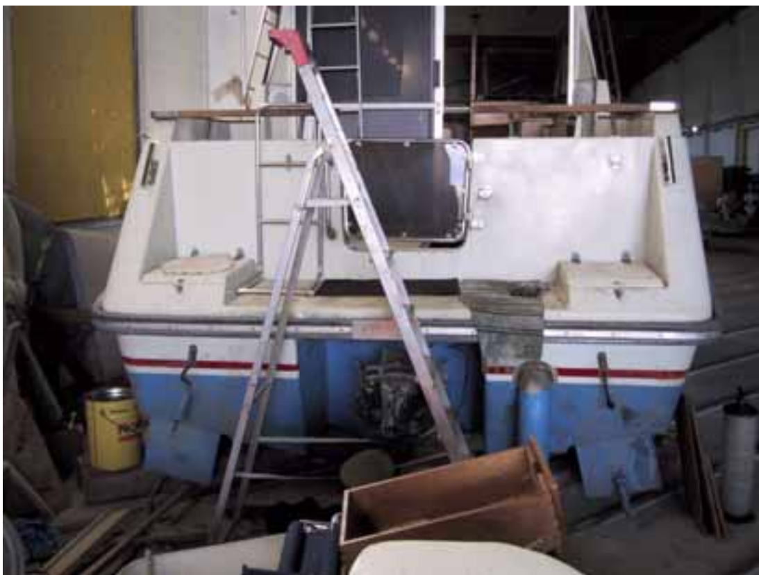
Kuva 6. Veneen perä. Kuvassa näkyy uimataso ja uimatason ja avotilan välille tehty kulkuaukko ovineen peräpeilissä. Kuvan ovi on onnettomuushetkellä peräpeilissä ollut ovi, joka veneen korjauksen yhteydessä vaihdettiin toisen tyyppiseen. Uimatason kummallekin laidalle muodostui mereen päin tiiviit kotelot, jotka lisäsivät perän kantavuutta.
