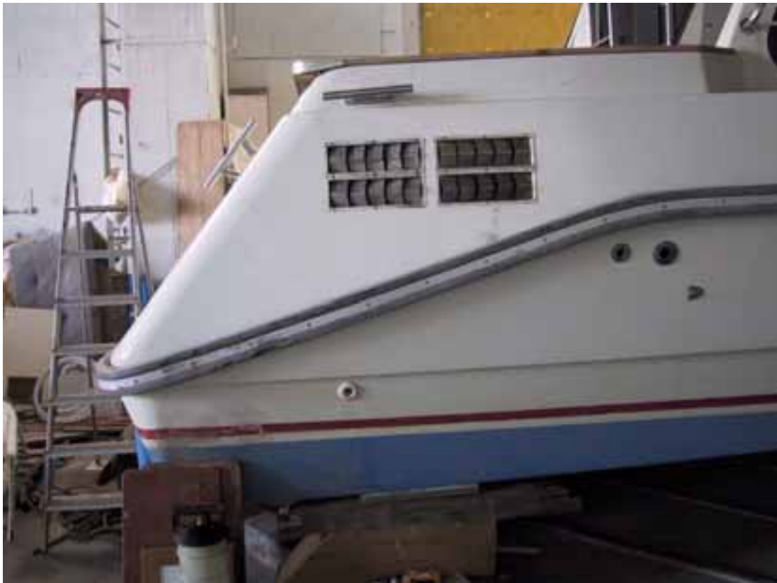
Kuva 13. Onnettomuusveneen oikean kyljen peräosa. Kuvassa näkyy konetilan ilmanottoaukot ja muut kyljessä olleet läpiviennit. Vasen kylki oli symmetrisesti samanlainen.
