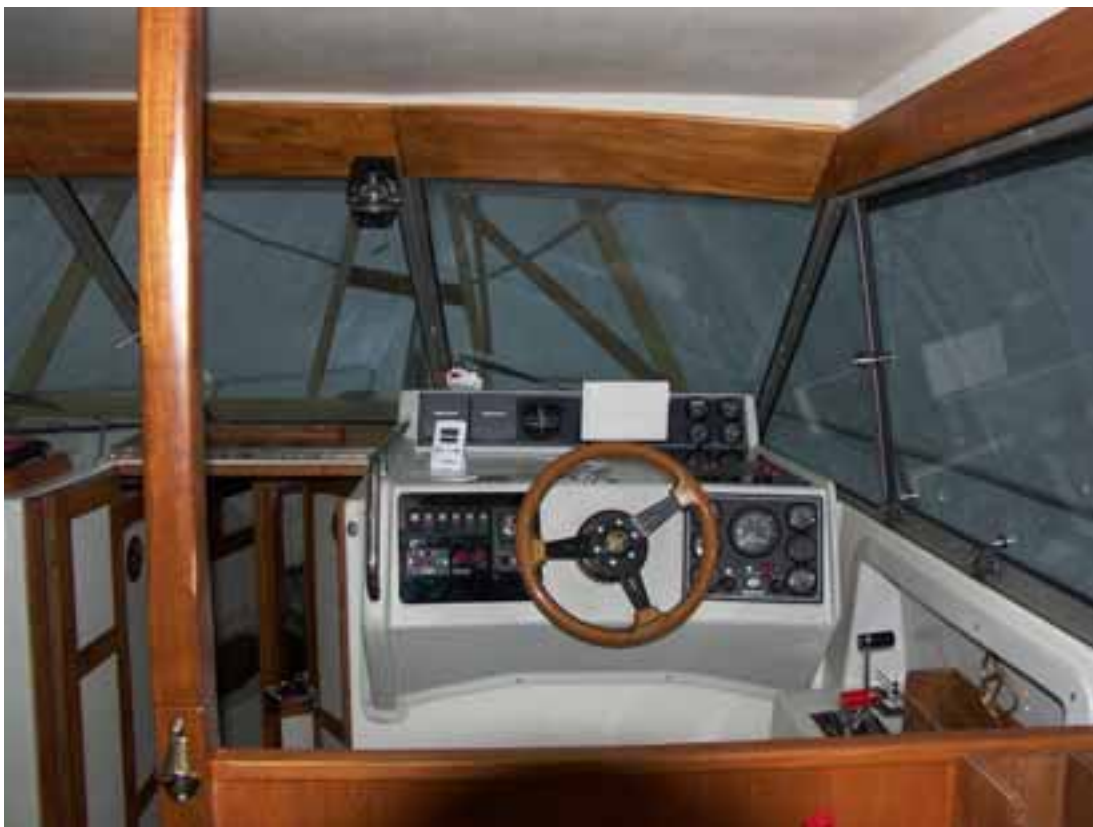
Kuva 19. Onnettomuusveneen sisäohjaamo. Tuulilasi on voimakkaasti kallistettu taaksepäin ja mittareita on sijoitettu tuulilasin alapuolelle siten, että mittarivalojen heijastukset näkyvät tuulilasissa kuljettajan näkökentässä. Kuva on otettu veneen korjaamisen jälkeen vuonna 2004.
