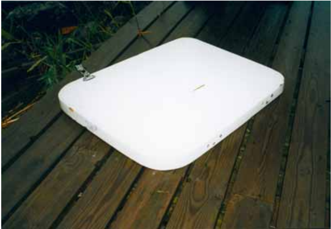
Kuva 12. Peräpeilin kulkuluukku irronneena tapahtuman jälkeen.
