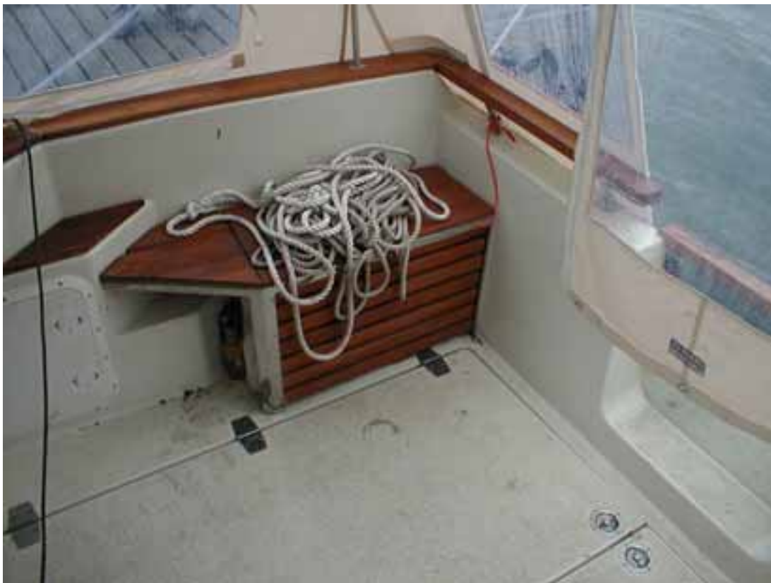
Kuva 9. Onnettomuusveneen avotilan peräosa konetilan luukun ollessa suljettuna. Kuvassa näkyy alueen järjestely ja kulkuaukon kynnyshöheys avotilan kanteen nähden.
