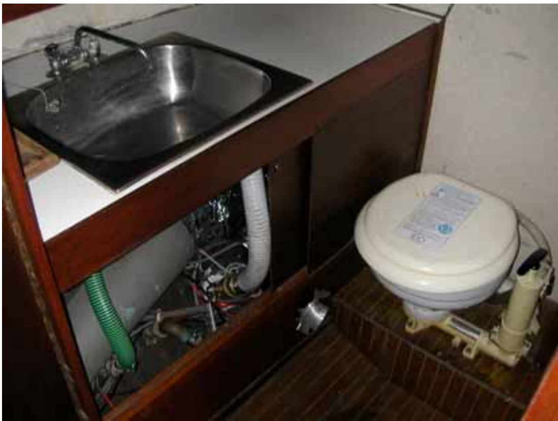
Kuva 2. Onnettomuusveneen WC salongista nähtynä. Kuvassa näkyy pohjaventtiilin sijainti ja niiden käsikahvojen luoksepäästävyys. Vaurioitunut venttiili on oikeapuoleinen (suurempi) venttiili.
