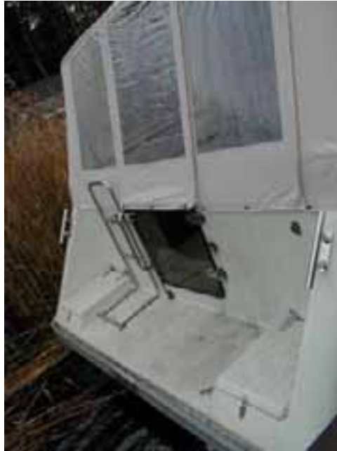
Kuva 10. Sun 33:n peräpeilin taakse rakennettu uimataso ja sen kulmissa olevat peräkoteloiden kannet. Kuva on otettu korjauksen jälkeen.
