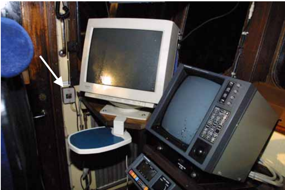
Kuva 4. Hinauskoukun laukaisupainike, kummallakin puolella komentosiltaa.
