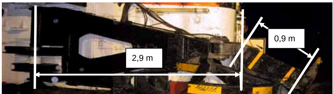
Kuva 3b. PEGASOSin hinauskoukun kiinnitysjärjestely kuvattuna välittömästi aluksen noston jälkeen. Hinauskaaren säde oli noin 2,9 m. Tällä etäisyydellä oli nivelakseli, jonka ympäri koukku pääsi kääntymään ylöspäin 90^\circ astetta.
