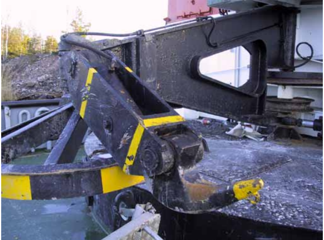
Kuva 3a. PEGASOSin hinauskoukku laukaistuna.
