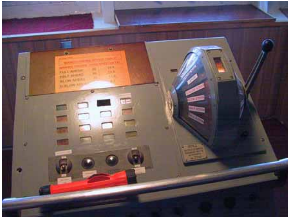
Kuva 8. MSC HINA, konekäskyvälitin ja ohjailunopeustaulukko.
