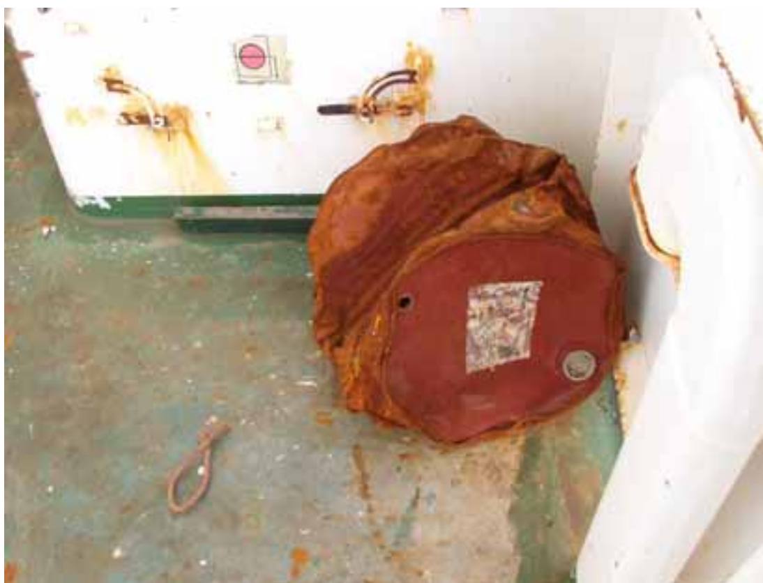
Kuva 9. Sääkannella ajelehtimisen aikana ruhjoutunut tynnyri.
