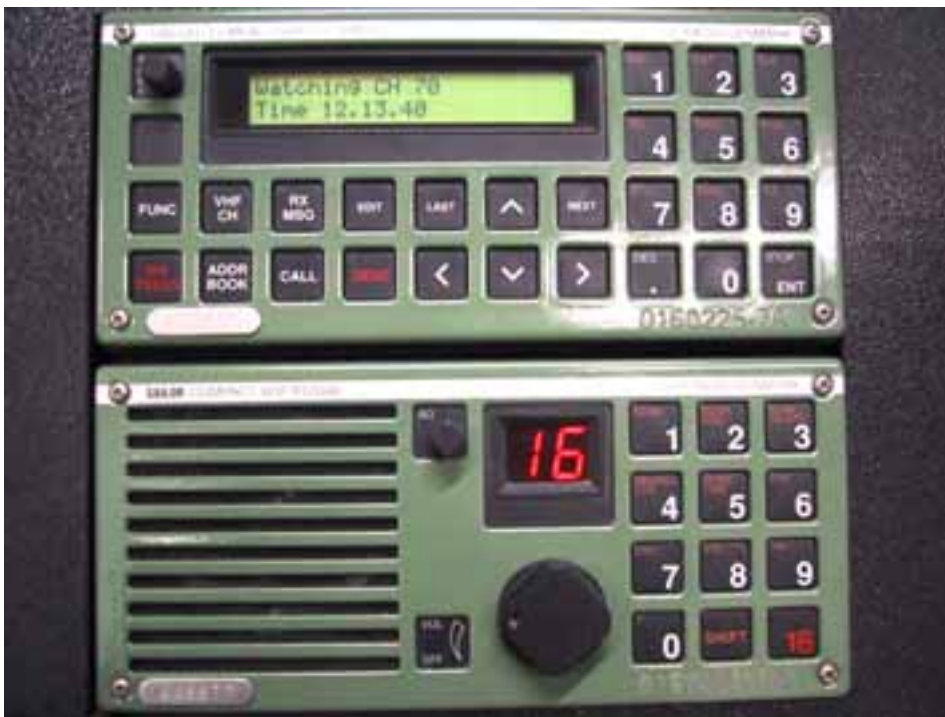
Bild 6. En VHF-DSC-apparat med en VHF-radiotelefon nedanför. Notera DSC-apparatens nödtangenter "DISTRESS" och "SEND".
