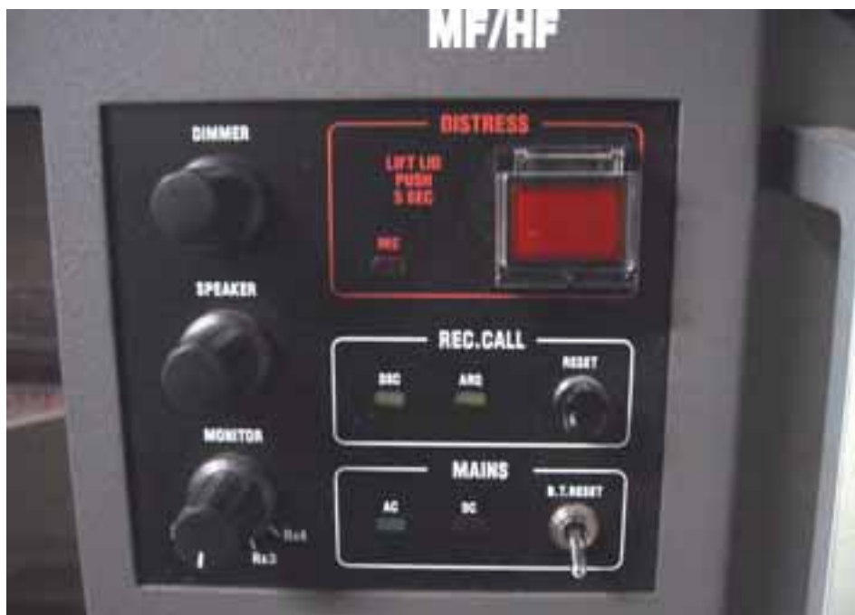
Bild 9. Nöd tangenten på MF/HF-radiotelefonens DSC-apparat är skyddad av ett lock.
