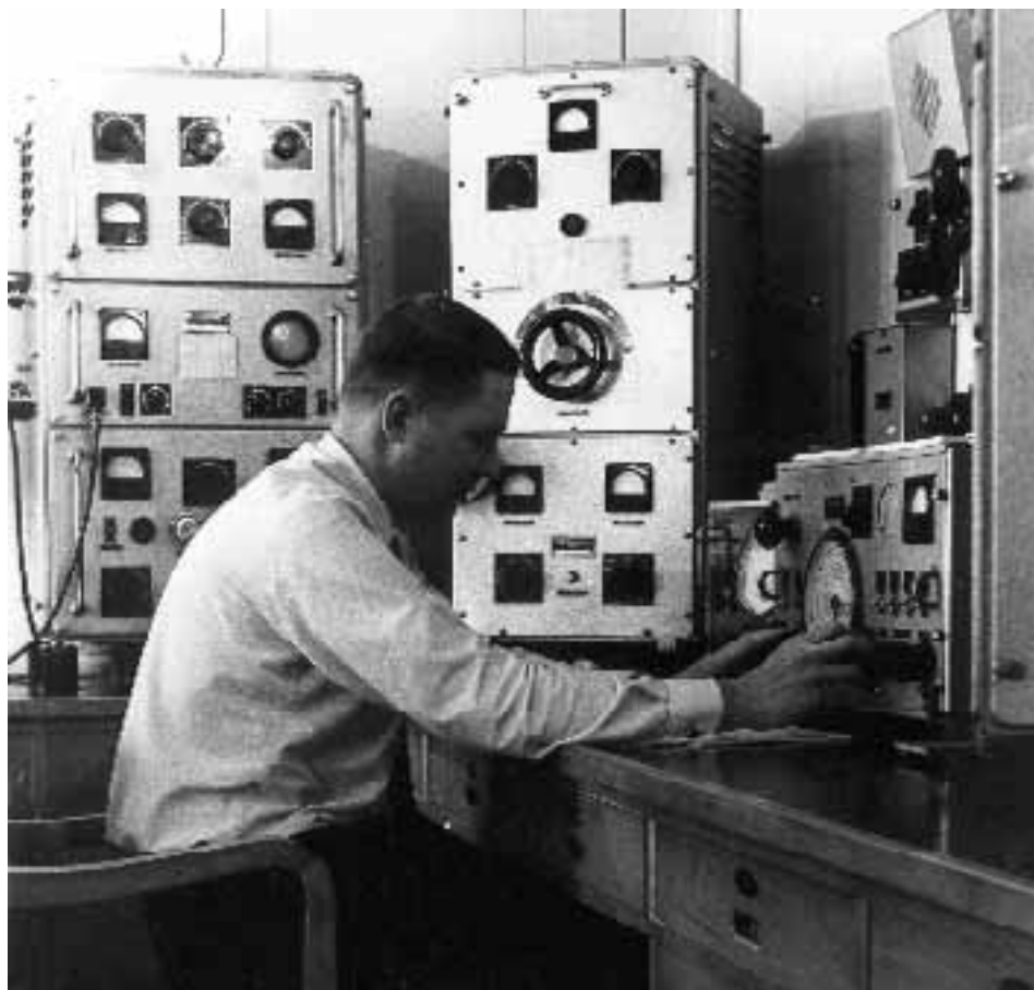
Bild 10. Radiotelegrafstation av äldre modell, MS Angra. Sändarna är tillverkade av finska Star-Radio.
