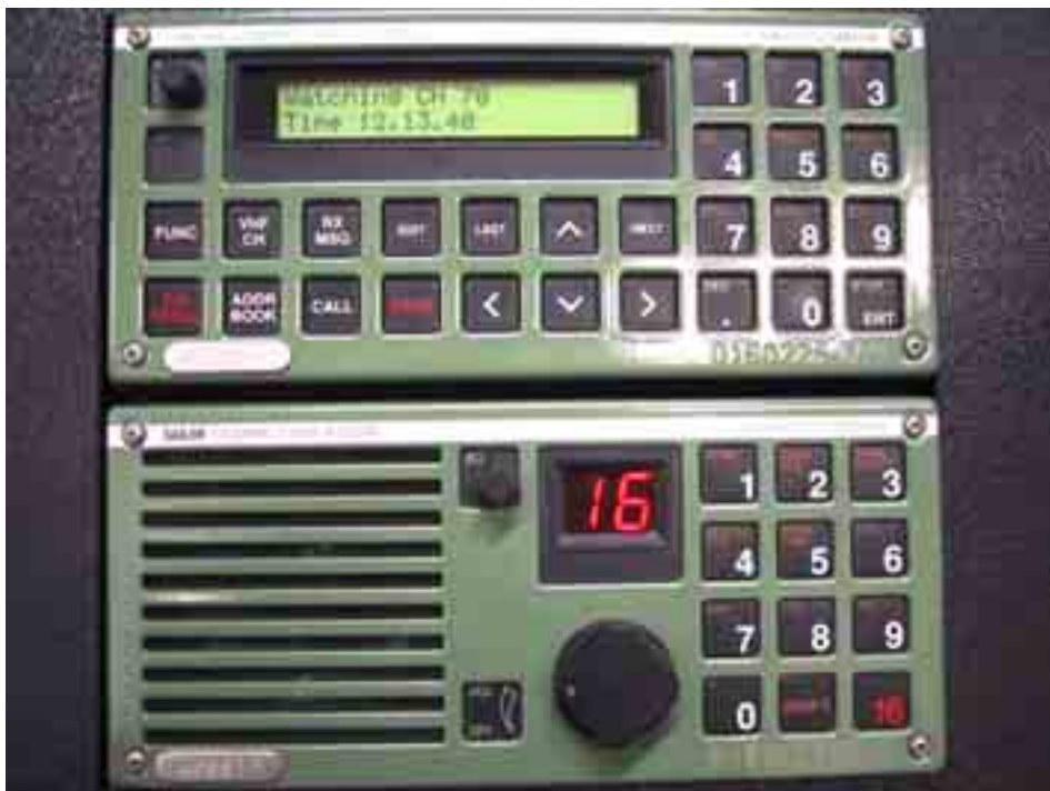
Kuva 6. VHF-DSC-laite ja sen alapuolella VHF-radiopuhelin. Huomaa DSC-laitteen hätäpainikkeet "DISTRESS" ja "SEND".
