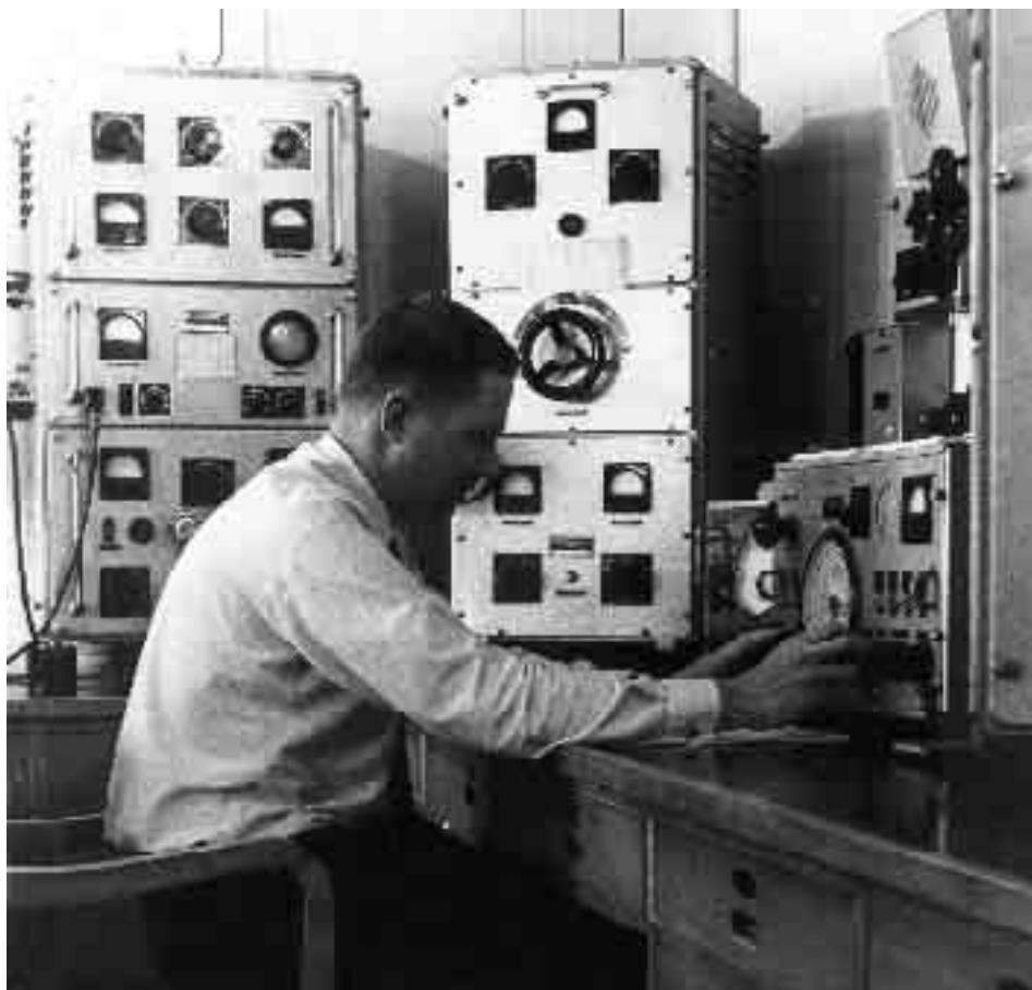
Kuva 10. Aluksen vanha radiosähkötysasema, ms Angra. Lähettimet ovat suomalaisen Star-Radion valmistamia.
