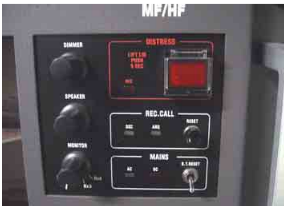
Kuva 9. MF/HF-radiopuhelimen DSC-laitteen hätäpainike on läpän takana.
