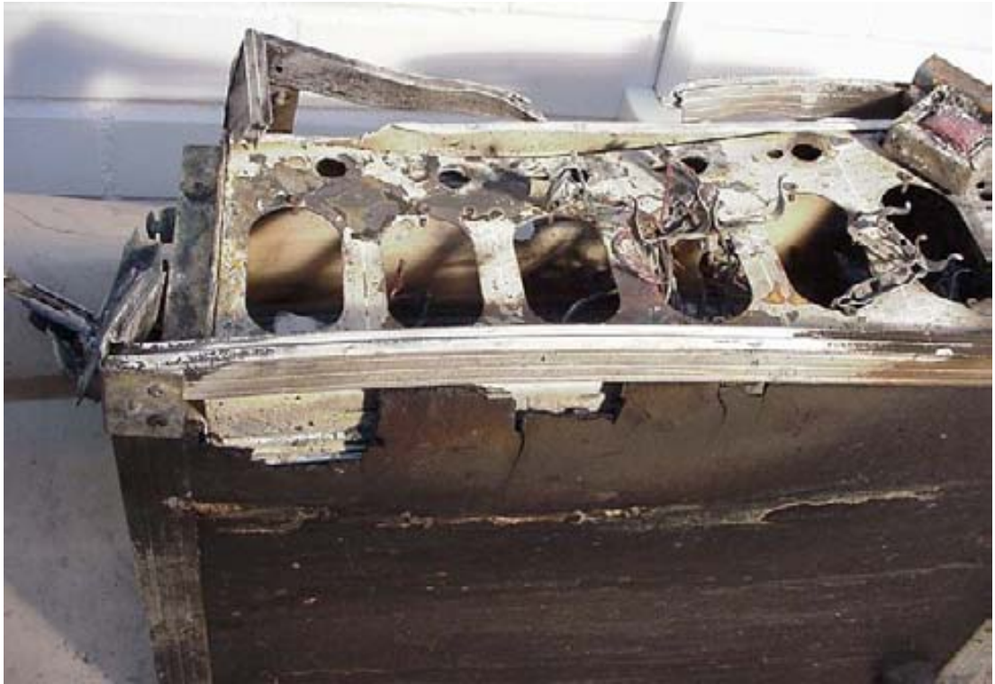
Kuva 7. Himmentimen toisella pitkällä sivulla on ollut kuusi kaksoissuojakosketin-pistorasiaa, joihin lavastelamppurivistöt oli kytketty. Himmentimen ohjaus-elektronikka toimi tietokoneohjauksella.
