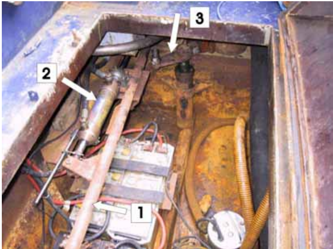
Kuva 11. Yhdistetty peräsinkone- ja akkutila. Akkujen yläpuolella peräsimien yhdystanko (1) ja työsylinteri (2) sekä oikeanpuoleisen peräsimen akselin yläpää ja kääntövarsi (3). Huomaa, että yhdystanko on irrotettu kääntövarresta.
