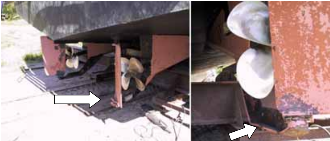
Kuva 10. Valokuvat vääntyneestä kalaraudasta (nuoli) ja jumiutuneesta oikeanpuoleisesta peräsimestä. Huomaa vahingoittumattomat potkurit.
