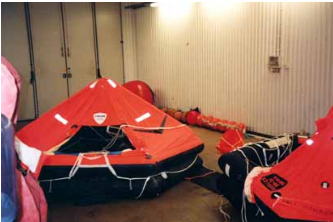
Kuva 4. KINGSTONin pelastuslautat tuotuna Gävlen rannikkovartioasemalle. Lauttoissa ei ollut jälkiä käytöstä. Ne ovat lauenneet automaattisesti aluksen upottua.
