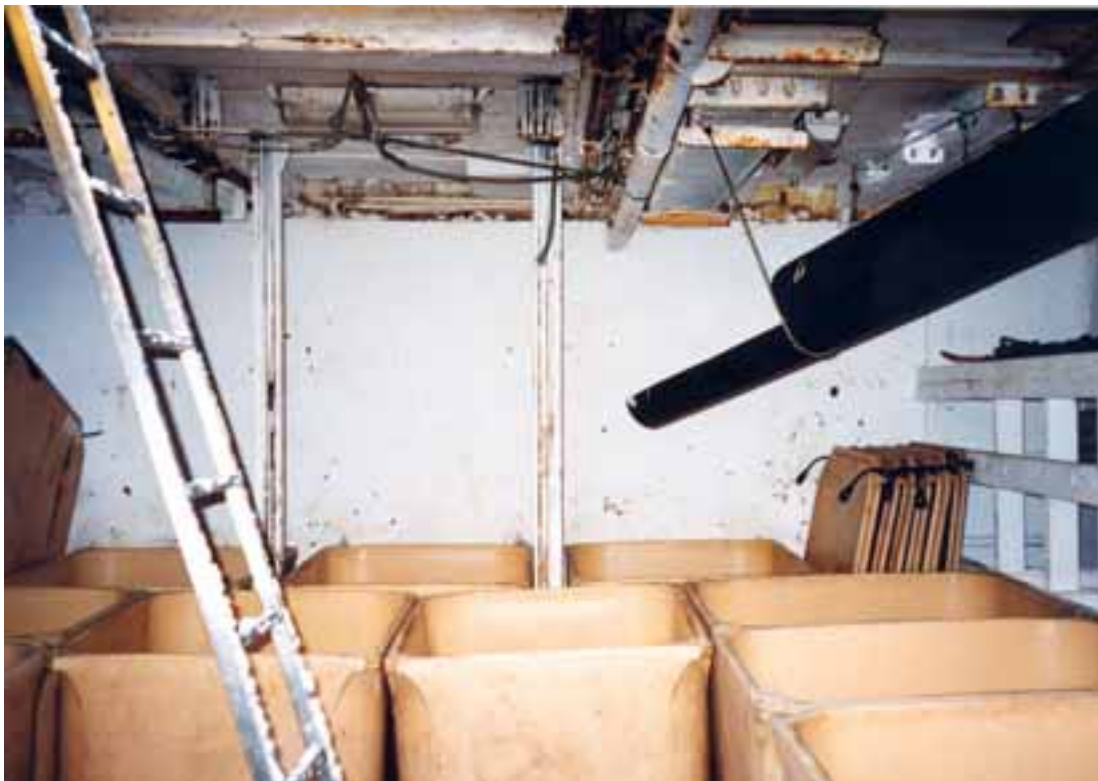
Kuva 12. Sisaraluksen kalaruuma, jossa kalakontteja. Oikealla ylhäällä kalojen siirtoputki shelter-kannen alta.
