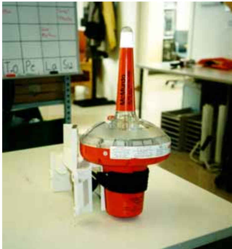
Kuva 11. Samanlainen 406 MHz EPIRB-poiju kuin KINGSTONille toimitettu.
