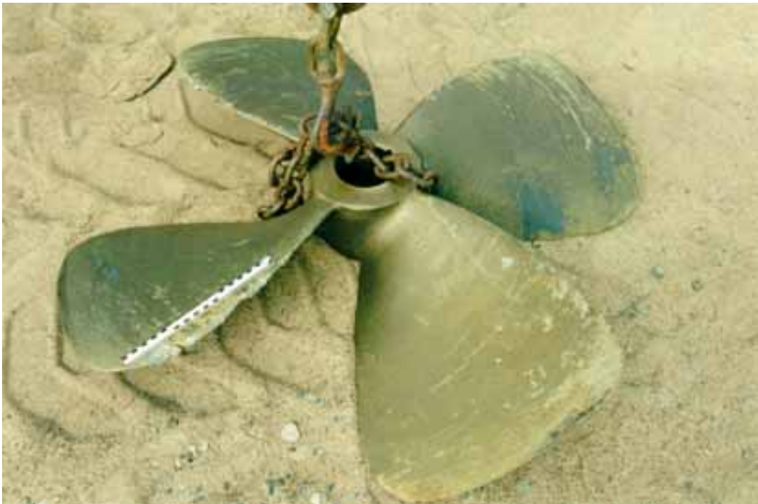
Kuva 4. ARSKAn potkurinlavan vaurioita.
