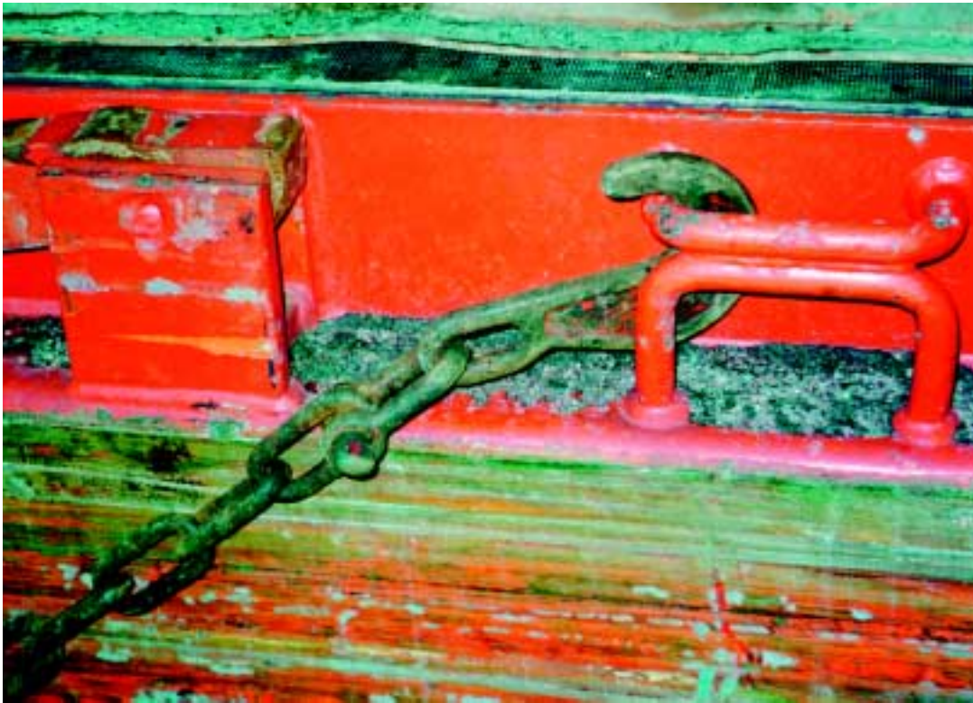
Kuva 17. Esimerkki koukun vinosta kiristyksestä.
