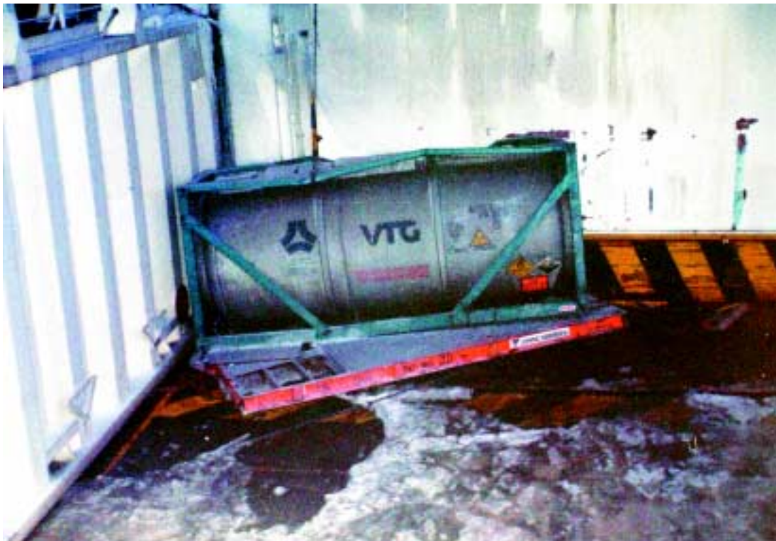
Kuva 6. Vaurioitunut säiliökontti ja lauttavaunu kiinnitettynä aluksen oikealle laidalle. (Kuvattu Raumalla 31.1.1998)
