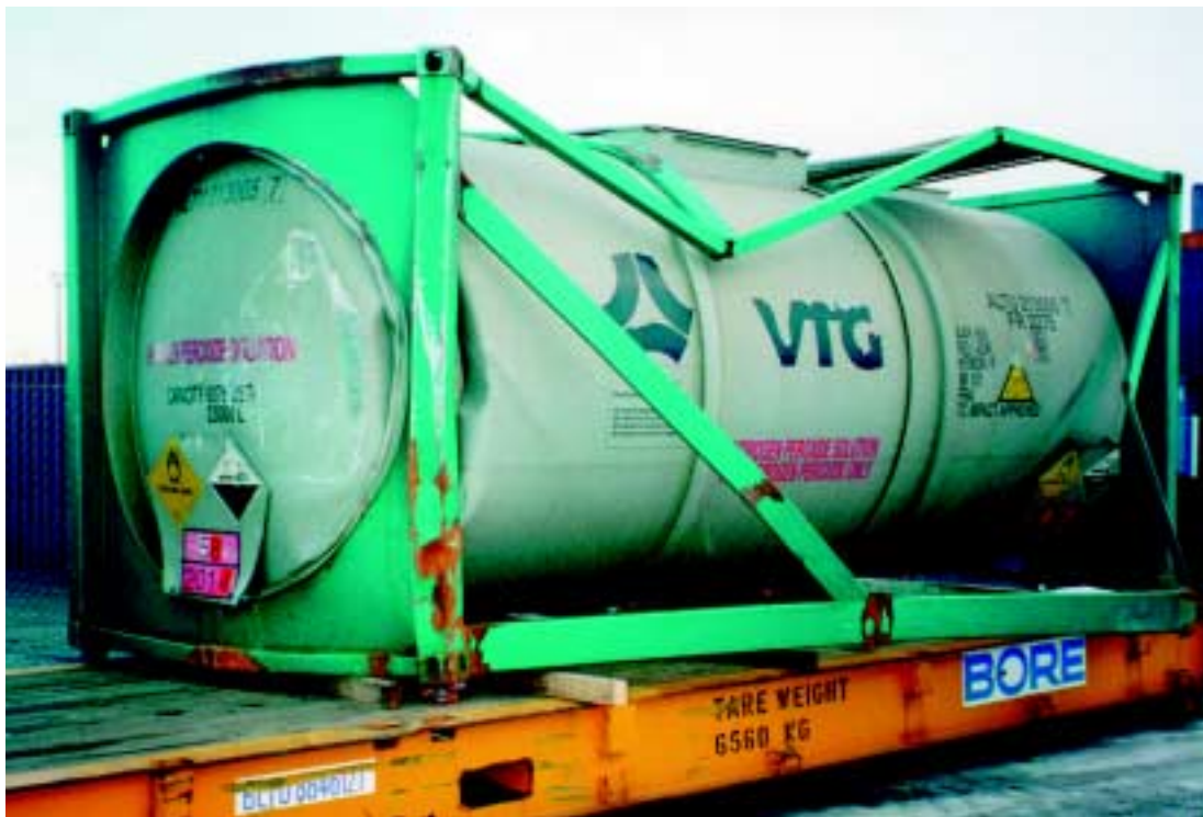
Kuva 7. Vaurioitunut säiliökontti valokuvattuna Raumalla
