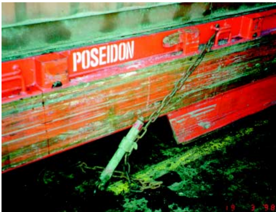
Kuva 10. Esimerkki lauttavaunun kiinnityksestä.
