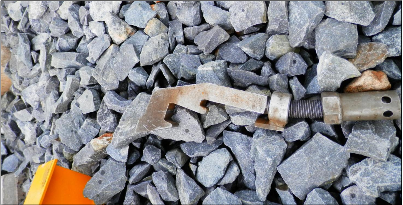
Kuva 8. Vaihteen V114 kielissä ollut kielisalpa, joka vääntyi ja irtosi ratatyökoneen ajaessa vaihteen auki. (Kuva: OTKES)
