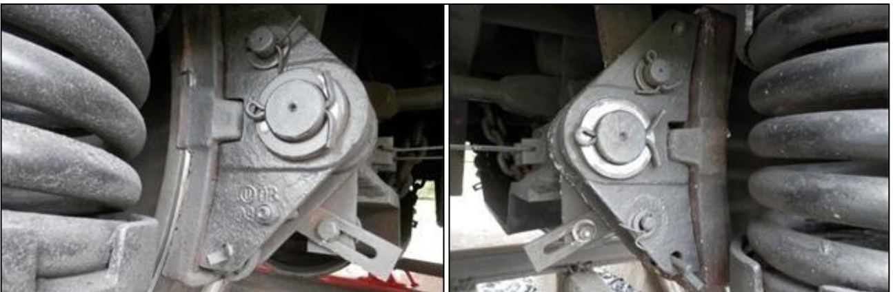
Kuva 16. Paikkatutkinnassa 3.7.2017 dokumentoitu ratatyökoneen 1. telin oikean puolen jarrutönkkien kunto, vasemmalla kuvassa 2. ja oikealla 1. pyöräkerta. (Kuvat: OTKES)
