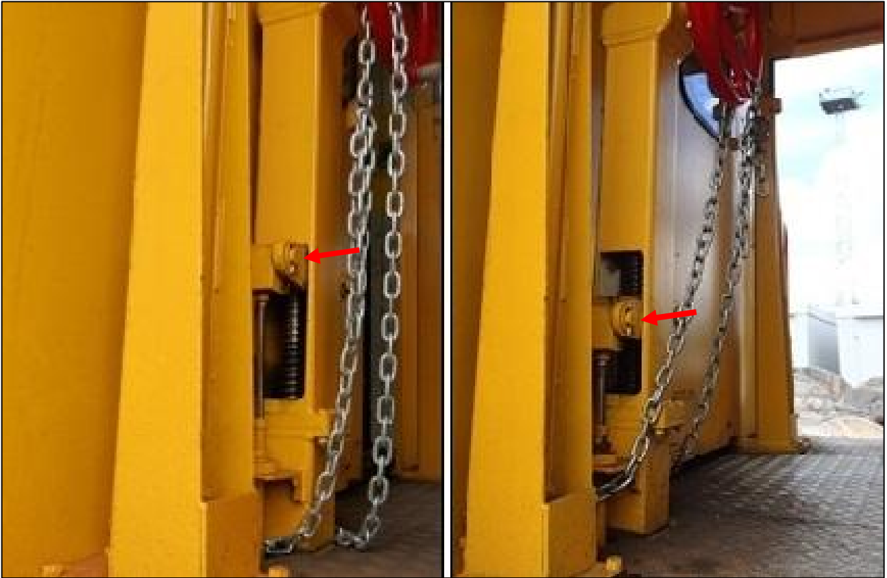
Kuva 17. Seisontajarrun käyttömekanismin dokumentoitu asento (nuolet) seisontajarrun ollessa kiinnitettynä, vasemmalla 3.7.2017 paikkatutkinnan yhteydessä otettu kuva ja oikealla 13.7.2017 paikkatutkinnan yhteydessä otettu kuva. (Kuvissa näkyvä ketju on vaaratilanteen jälkeen seisontajarrumekanismiin lisätty lukitus, joka estää seisontajarrun luvattoman avaamisen.) (Kuvat: OTKES)
