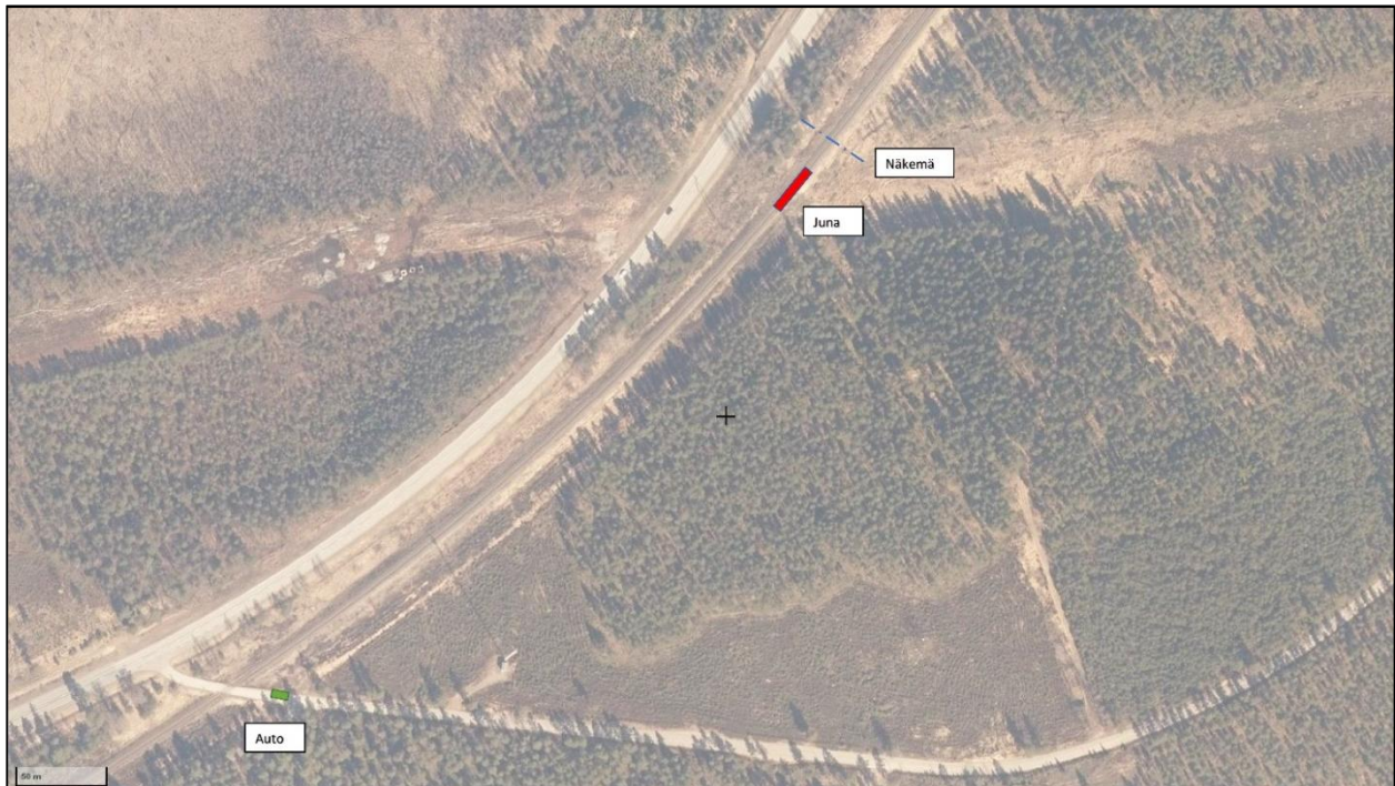
Kuva 20. 13 sekuntia ennen törmäystä: auto lähti liikkeelle 30 m päästä radasta, juna lähestyi 400 m päässä tasoristeyksestä nopeudella 112 km/h. Kuvaan merkitty myös näkemä junan tulo-suuntaan (437 m tasoristeyksestä). (Pohjakartta: Ortoilmakuva ©Maanmittauslaitos 1/2014, merkinnät: OTKES)
