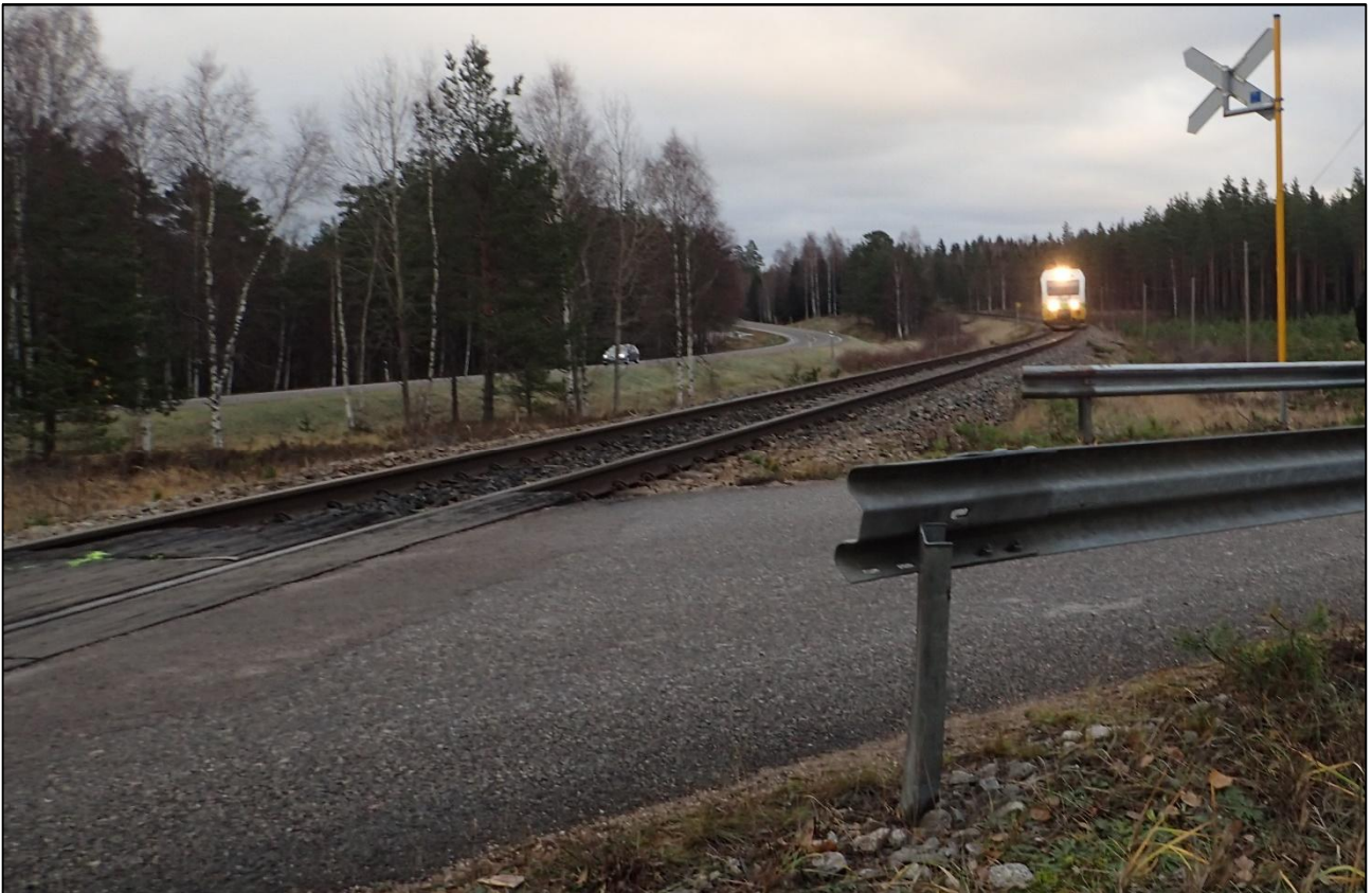
Kuva 17. Kiskobussin valot erottuvat ympäristöstä hyvin. Kiskobussi lähestyy Skogbyn tasoristeystä samasta suunnasta kuin onnettomuudessa. Onnettomuushetkellä oli hämärämpää ja satoi räntää, maa oli valkea lumesta. (Kuva: OTKES)
