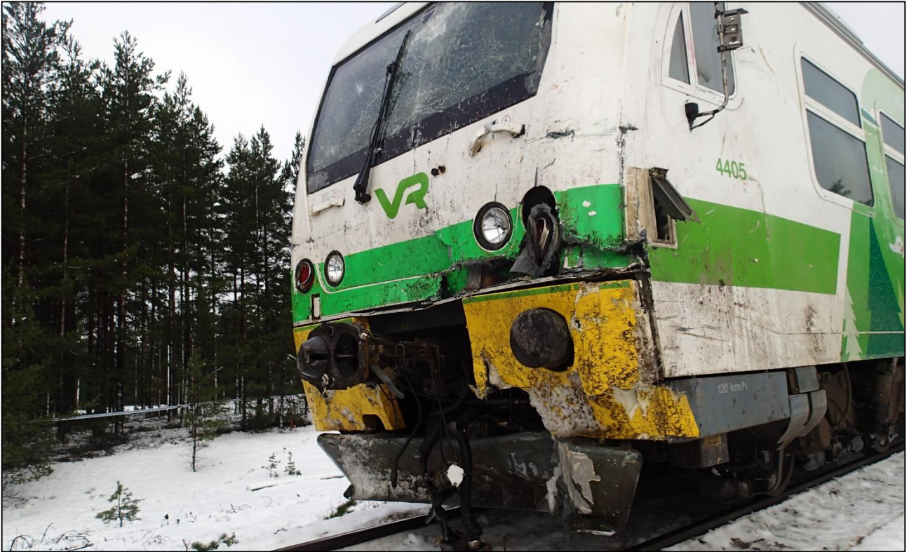
Kuva 9. Kiskobussin keulan vauriot. (Kuva: OTKES)
