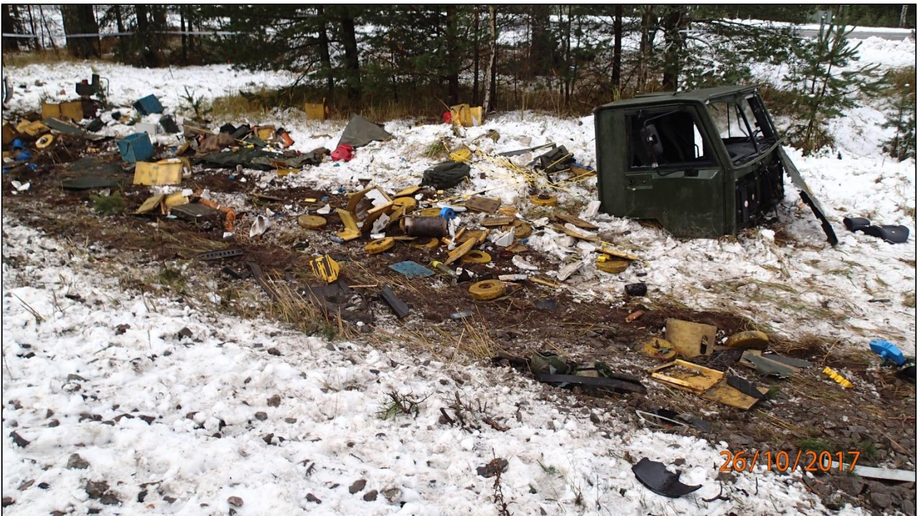
Kuva 8. Irronnut maastokuorma-auton hytti sekä tavaratilasta levinneitä harjoitustelamiinoja ja muuta materiaalia. (Kuva: OTKES)
