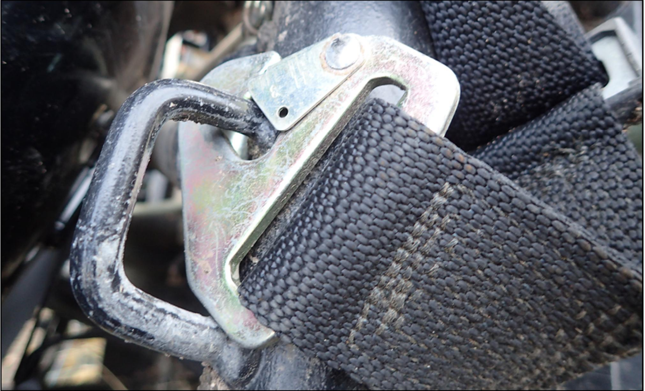
Kuva 12. Maastokuorma-auton kuormatilaistuimien turvavöiden kiinnitykset tarkastettiin ja ne olivat kunnossa. (Kuva: OTKES)
