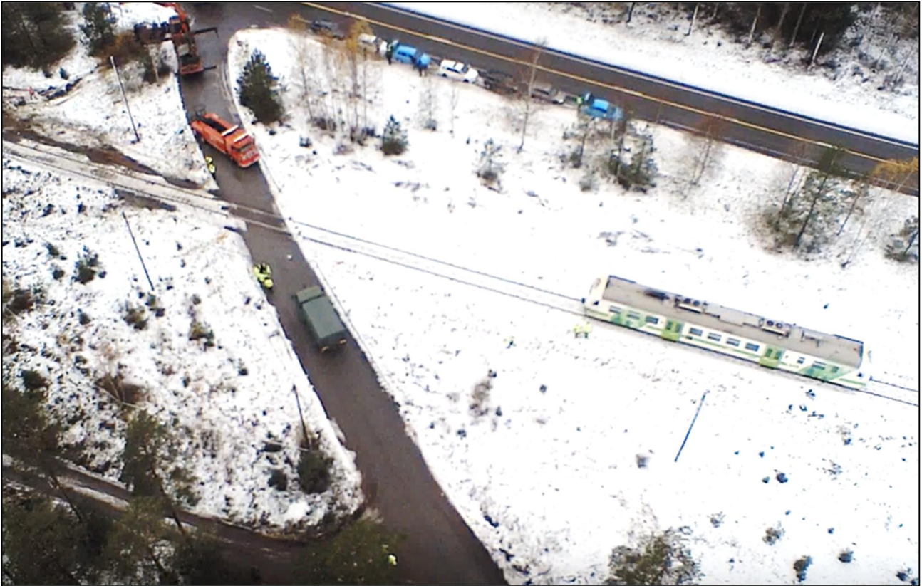
Kuva 14. Onnettomuudessa kiskobussi lähestyi maastokuorma-autoa takaviistosta tasoristeyksen kulman vuoksi. Kuva rekonstruktiosta. (Kuva: OTKES)
