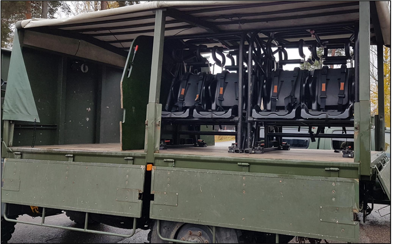
Kuva 10. Maastokuorma-auton kuormatilaistuintimet kahdeksalle henkilölle. Edessä väliseinällä erotettu tavaratila. (Kuva: OTKES)
