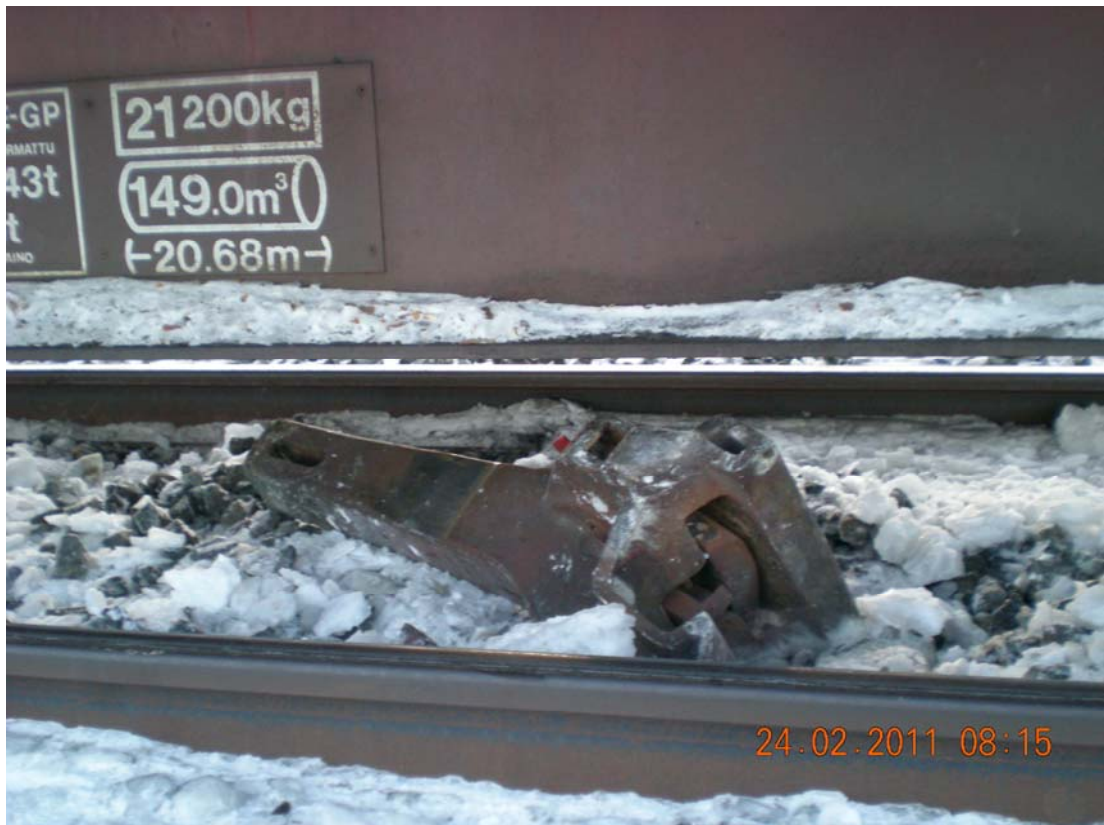
Kuva 2. SA3-automaattikytkin löytyi kahdeksannen vaunun alta.
