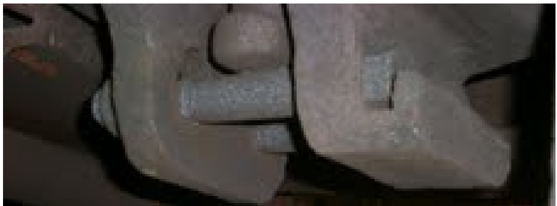
Bild 6. Dragbygel till SA3-kopplingsanordning med hylla.
