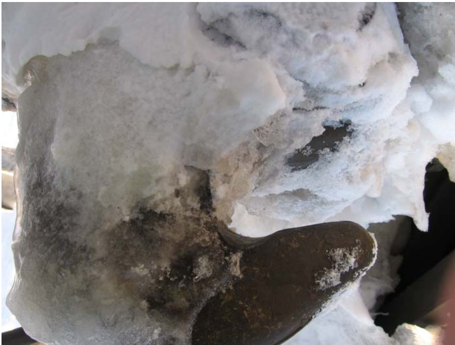
Kuva 8. Myös vetokoukun sisällä oli jäätä.
