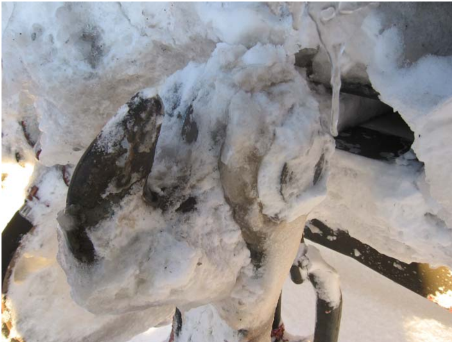
Kuva 7. Ex-vaunun eteläpään vetokoukku, josta kytkinlenkki oli irronnut, oli jäinen.
