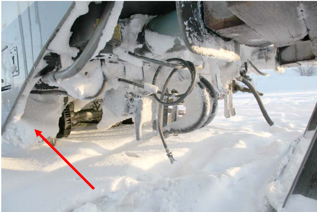
Kuva 9. Ex-vaunun eteläpäädyn (irronnut väli) WC:n lavuaarin poistoputken ympäristössä oli paljon jäätä ja lunta. (kuva poliisi)
