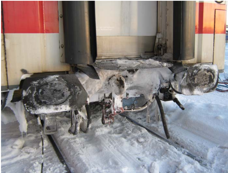
Kuva 6. Ex-vaunun eteläpäädyssä (irronnut väli) oli paljon jäätä ja lunta.
