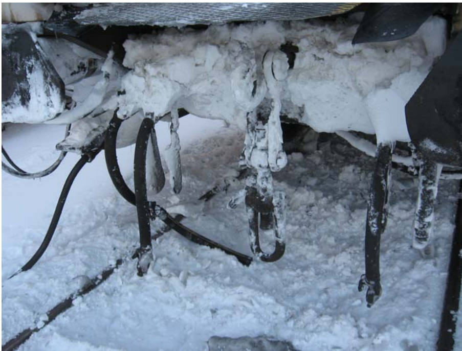
Kuva 5. Rx-vaunun pohjoispäädyssä (irronnut väli) oli paljon jäätä ja lunta. Kuva otettu Helsingissä raiteella 13 onnettomuuden jälkeen.
